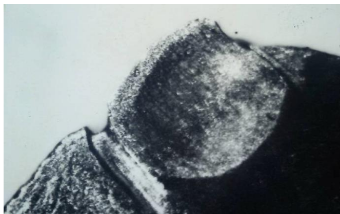
Рисунок 7 – Передня поверхня різця із сталі Р6М5 після точіння деталі із сталі 08X18Н10 з подачею S=0,09 мм/об. \times 100 , МОР – ріпакова олія
