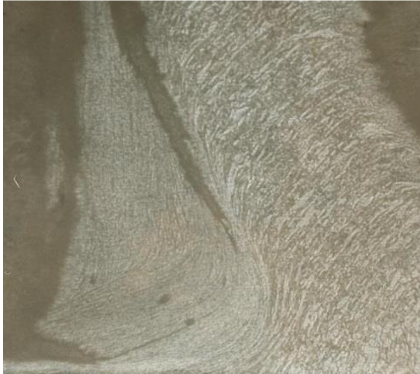
Рисунок 3.17 – Зона стружкоутворення при вільному ортогональному різанні сталі 08X18H10 зі швидкістю v = 0,15 м/с, s_z = 0,15 мм; різець – сталь Р6М5; \gamma = 15^\circ ; \rho = 0,008 мм; МОР – сульфофрезол
