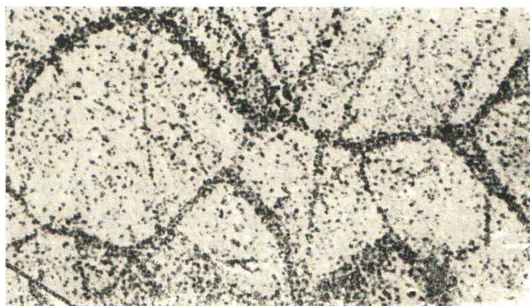
Рисунок 3.7 – Магнітна мікрофотографія сталі 12X15Г9НД (AISI 201) у незміцненому стані. Видно мікроструктуру границь зерен. x1000
