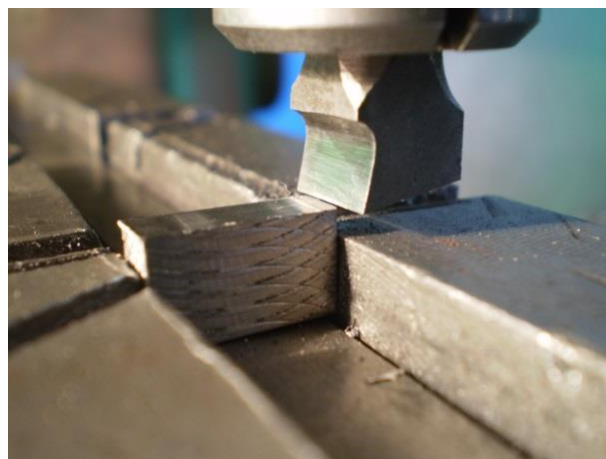
Рисунок 2.10 – Процес вільного прямокутного різання
