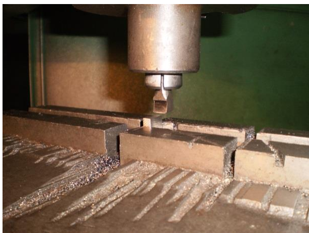
Рисунок 2.10 – Процес вільного прямокутного різання
