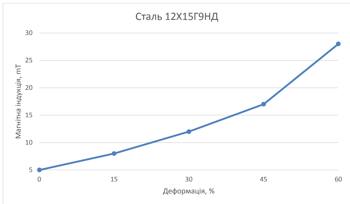
Рисунок 3.4 – Графік залежності зміни магнітної індукції від ступеню деформації сталі 12Х15Г9НД
