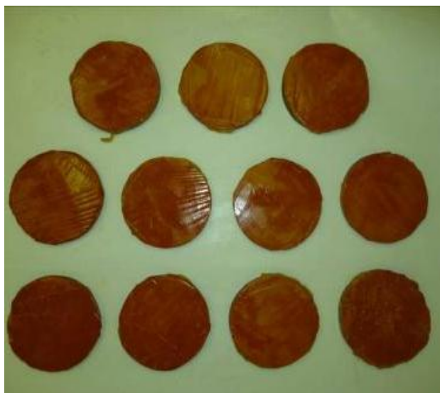
Рисунок 3.1 – Загальний вигляд підготовлених металевих основ із гідроізоляцією «Елімінатор» для укладання асфальтобетону литого
