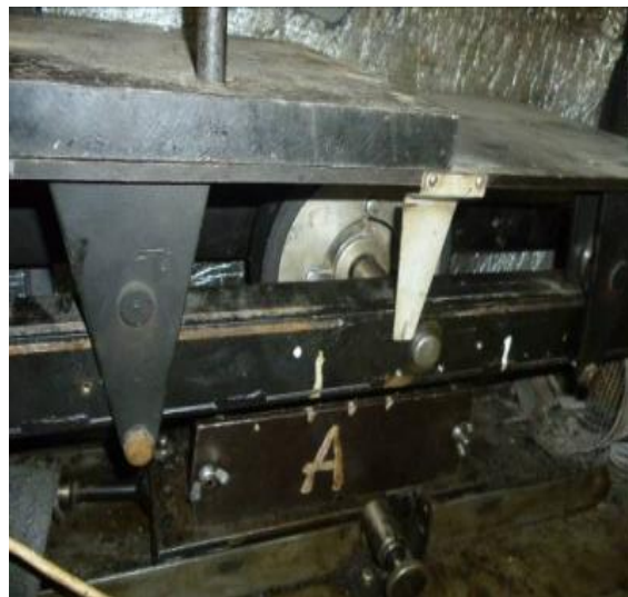
Рисунок 3.3 – Секторний прес для випробування на колійність щебенево-мастикового та литого асфальтобетону
