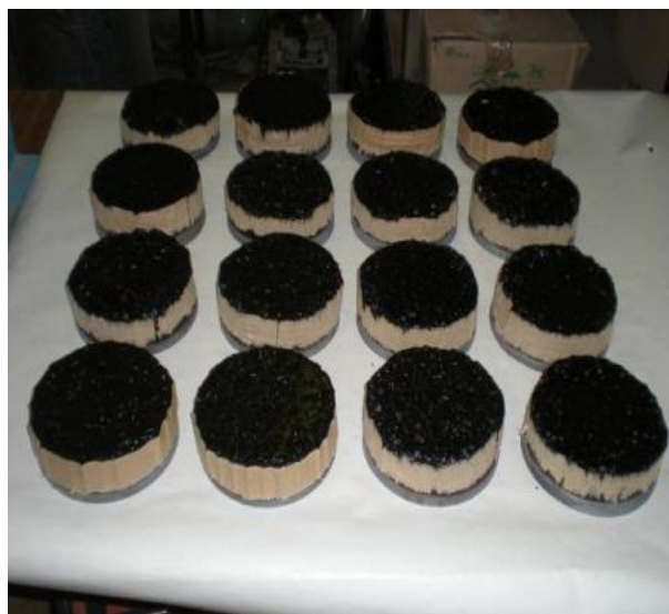
Рисунок 3.1 – Загальний вигляд підготовлених металевих основ із гідроізоляцією «Елімінатор» для укладання асфальтобетону литого
