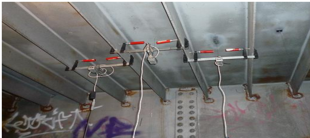
Рисунок В.4 – Фото датчиків для вимірювання локальних динамічних прогинів ортотропної плити
