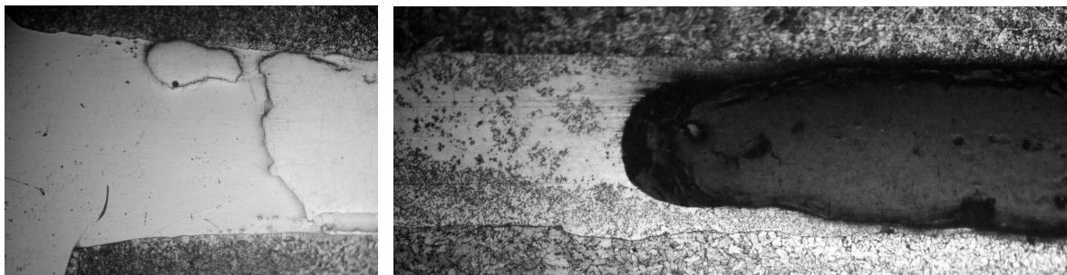
Рисунок 13 – Границі сплавлення між сталлю і міддю: а) із сторони зварного шва; б) із протилежної сторони від зварного шва
