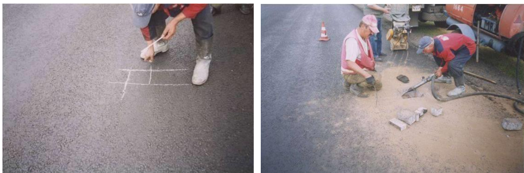
Рисунок А.17– Позначення характерних місць та відбір зразків з покриття для дослідження причин розшарування ЩМАС
