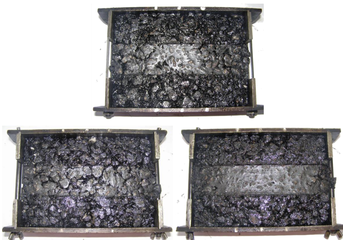
Рисунок 3.20 – Загальний вигляд зразків виготовлених із щебенево-мастикового асфальтобетону після випробування на колієстійкість
