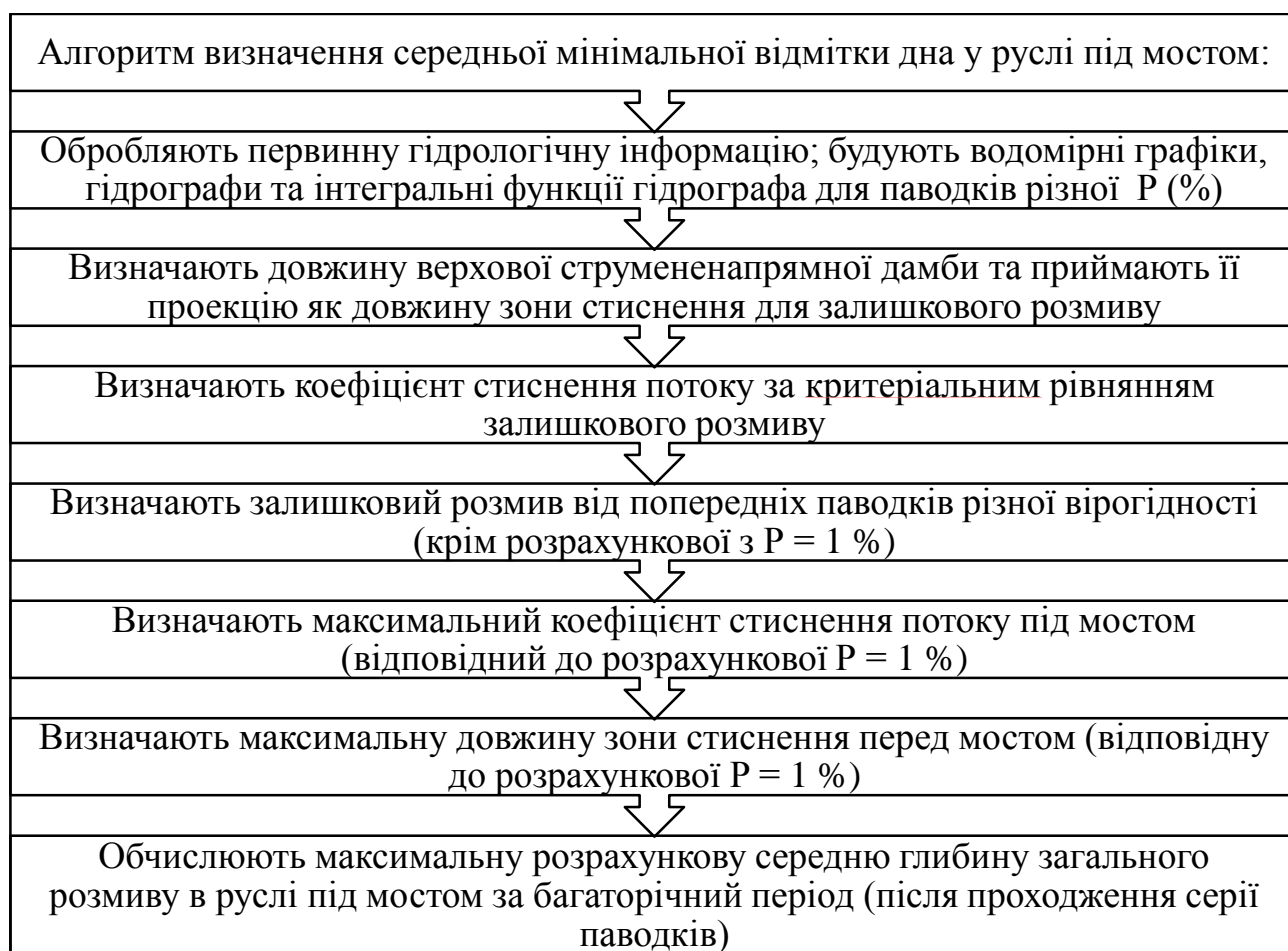
Рисунок 6 – Структурно-логічна схема багаторічного прогнозування руслових деформацій
