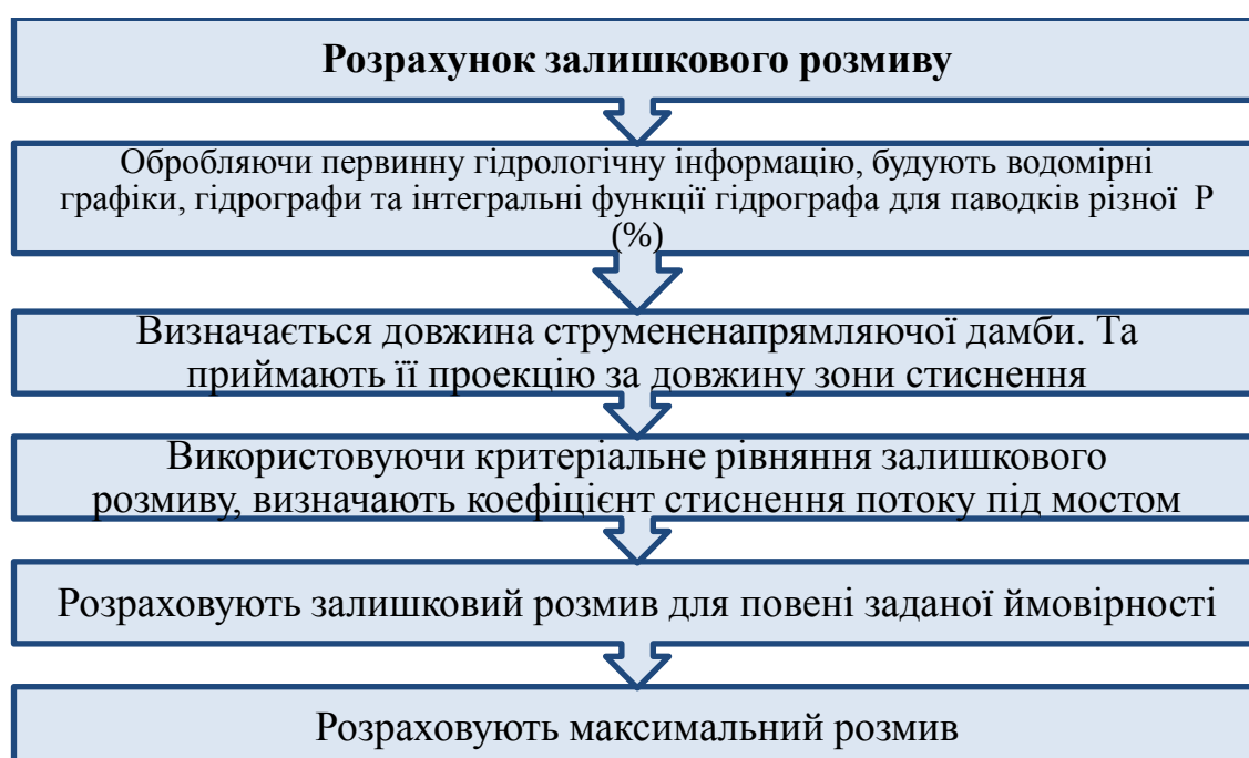
Рисунок 4.5 – Структурно-логічна схема методики розрахунку залишкового розмиву
