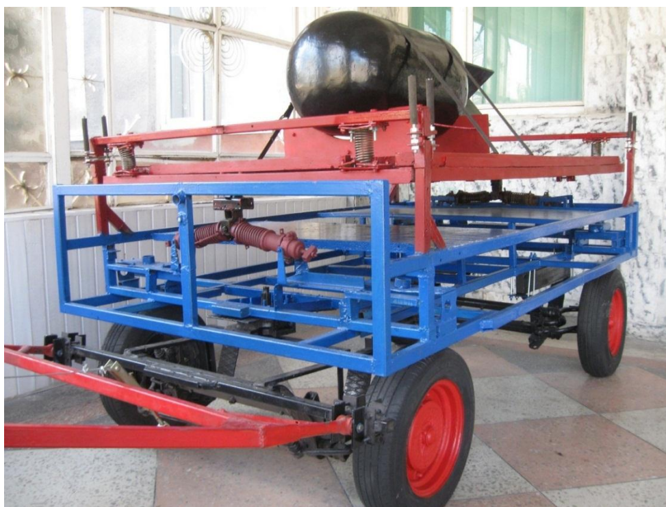
Рисунок 4.1 – Фотографія дослідного зразка спеціалізованого транспортного засобу для перевезення небезпечних вантажів
