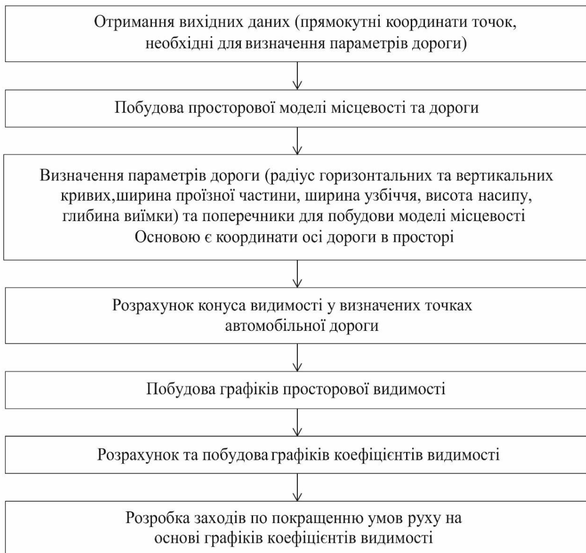
Рисунок 4 – Блок-схема розрахунку видимості та розробки заходів по її підвищенню
