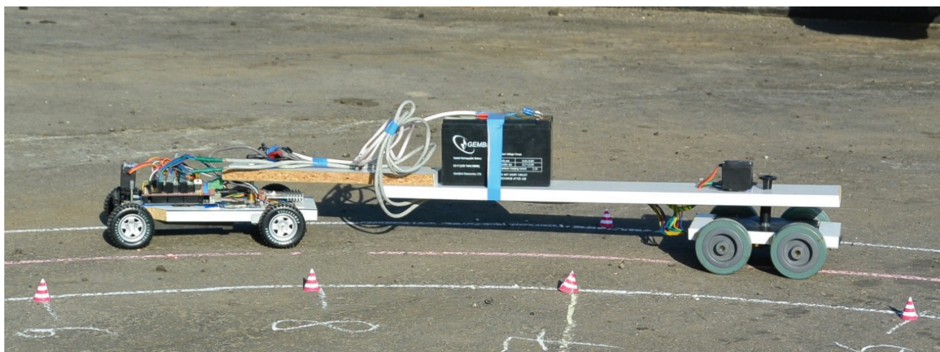
Рисунок 4 – Фізична модель автопоїзда з керованим напівприцепом з можливістю корекції траєкторії возика шляхом гальмування коліс одного з бортів
