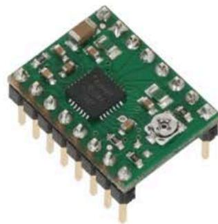
Рисунок 4.9 – Драйвер двигунів A4988
