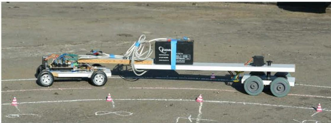
Рисунок 4.1 – Фізична модель автопоїзда з керованим напівпричепом з можливістю корекції траєкторії возика шляхом гальмування коліс одного з бортів
