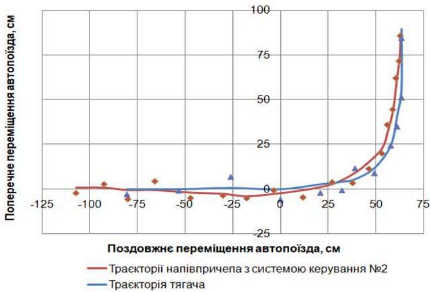
Рисунок 4.17 – До визначення траєкторії ланок автопоїзда з системою управління №2
