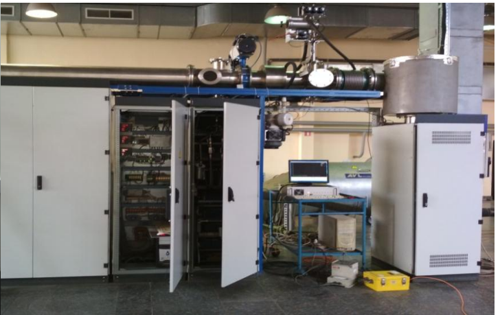
Рисунок 8 – Дослідна повнопотокова система відбору проб на основі універсальної системи відбору проб постійного об'єму (CVS) моделі EMMS-CVS-010
