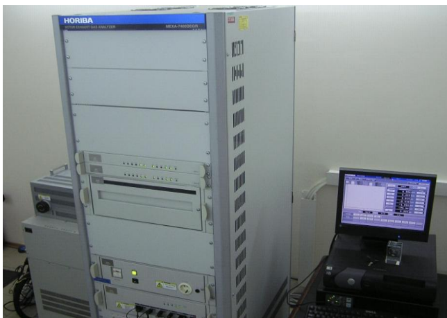
Рисунок 7 – Газоаналітична система стенді MEHA-7400DEGR вимірювання концентрації нормованих забруднюючих речовин у газах
