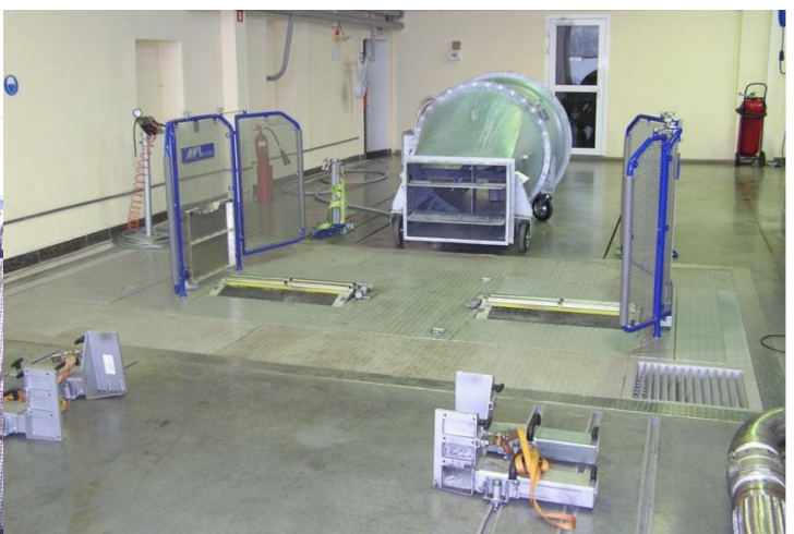
Рисунок 6 – Моделюючий роликовий стенді AVL типу RPL1220/12C23M17/APM150
