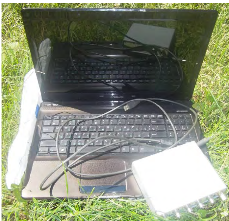
Рисунок 4.1 – Вимірювальний комплекс на базі USB-осцилографа і ПК
