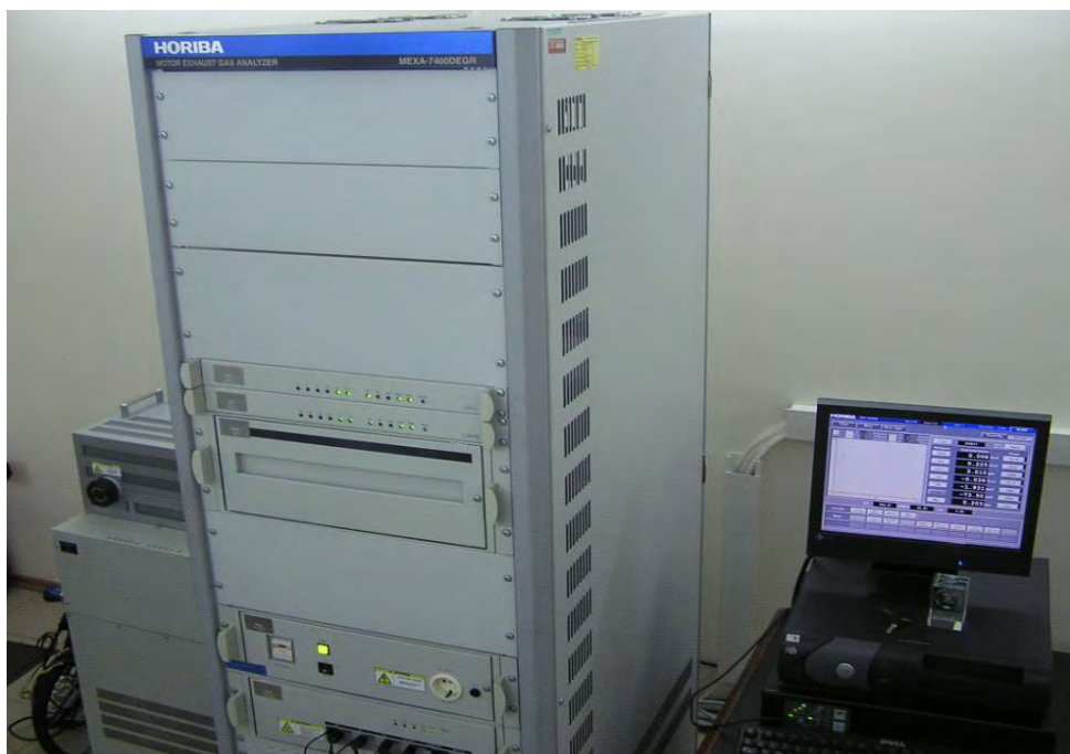
Рисунок 4.13 – Газоаналітична система MEXA-7400DEGR вимірювання концентрації нормованих забруднюючих речовин у газах
