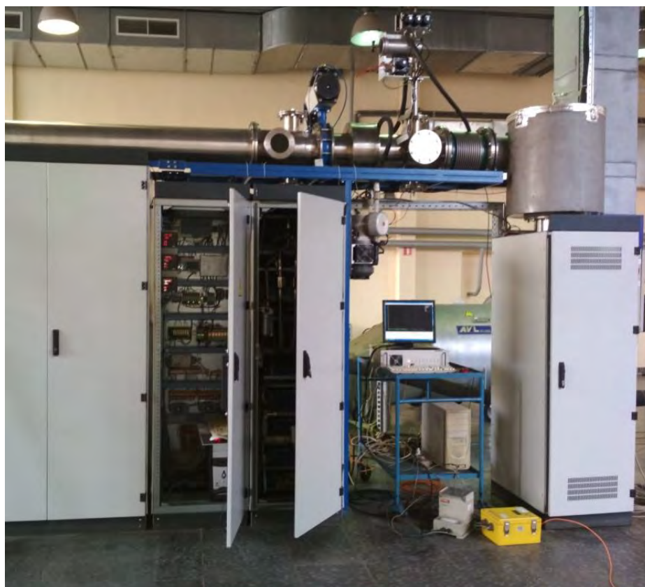
Рисунок 4.12 – Дослідна повнопотокова система відбору проб на основі універсальної системи відбору проб постійного об'єму (CVS) моделі EMMS-CVS-010
