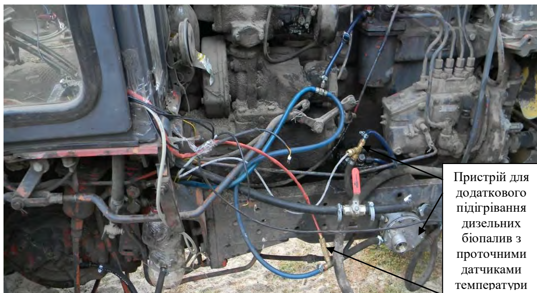
Рисунок 4.5 – Експериментальна установка з підігрівачем палива та проточними датчиками температури, створена на базі трактора ЮМЗ-6
