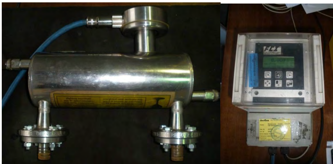
Рисунок 4.15 – Масовий витратомір палива коріолісового типу FlexCOR
