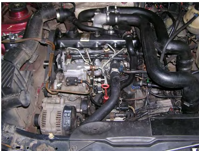
Рисунок 4.7 – Чотирициліндровий чотиритактний дизель VAG 1.9 TDI 1Z, встановлений на автомобілі Volkswagen Passat B4
