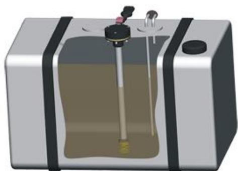
Рис. 1. Схематичне зображення встановлення датчика DUT-E 485 в паливний бак автобуса MAZ-206
