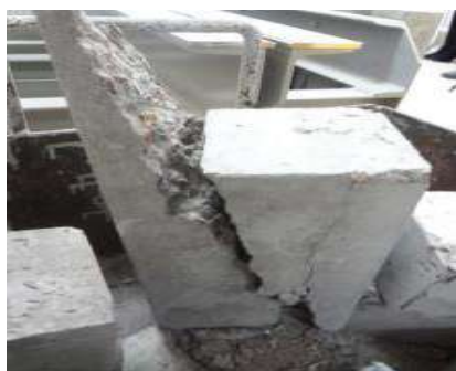
Рисунок 3.16 — Характерне руйнування зразка – призми і результати порівняння зразків з хімічними добавками на міцність при стиску призм
