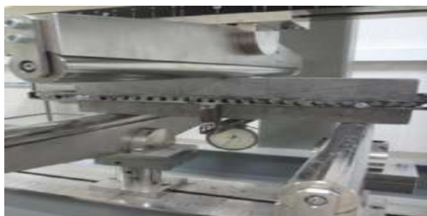
Рисунок 3.20 — Загальний вигляд при випробуванні цементобетонної призми на розтяг при згині
