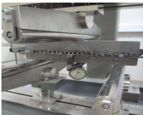
Рисунок 3.15 — Загальний вигляд при випробування цементобетонної призми на розтяг при згині і результати випробування на розтяг при згині
