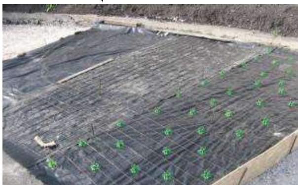
Рисунок Д.13 – Армуюча базальтова сітка на секції 4
