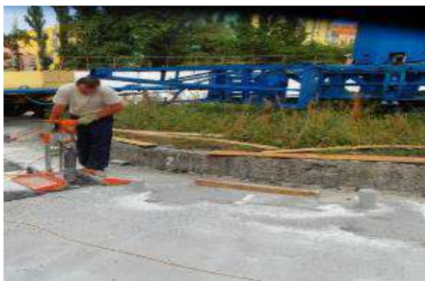
Рисунок Д. 29 – Відбір кернів на експериментальних секторах
