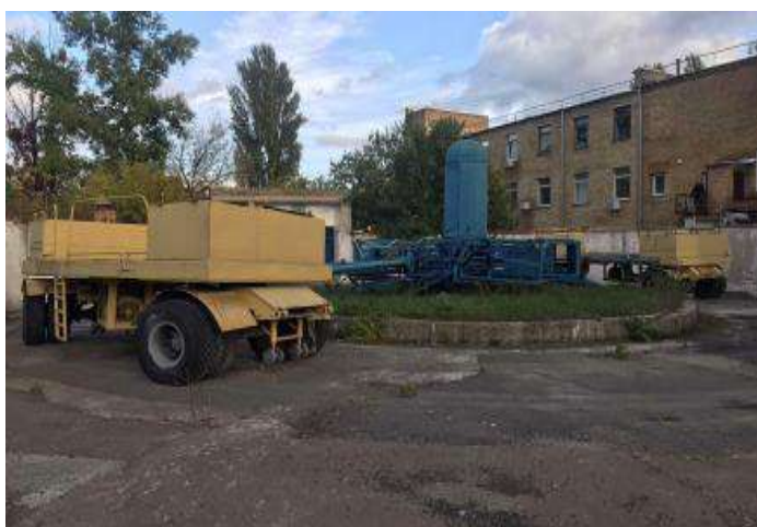
Рисунок 3.5 — Випробування конструкцій жорсткого дорожнього одягу на кільцевому стенді
