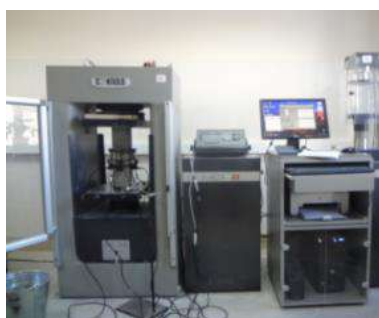
Рисунок 3.17 — Загальний вигляд обладнання при визначенні модуля пружності
