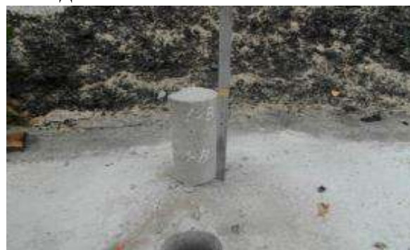
Рисунок Д.28 – Видалення цементного молока пешано-струйним методом
