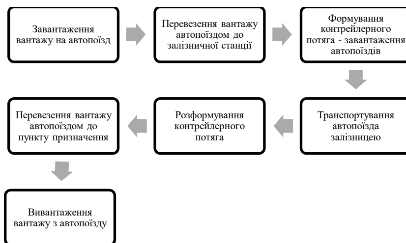
Рисунок 2.11 – Схема технологічного процесу контейлерного перевезення
