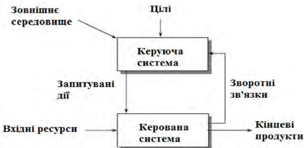
Рисунок 2.4 - Схема управління системою за методом GRAI
