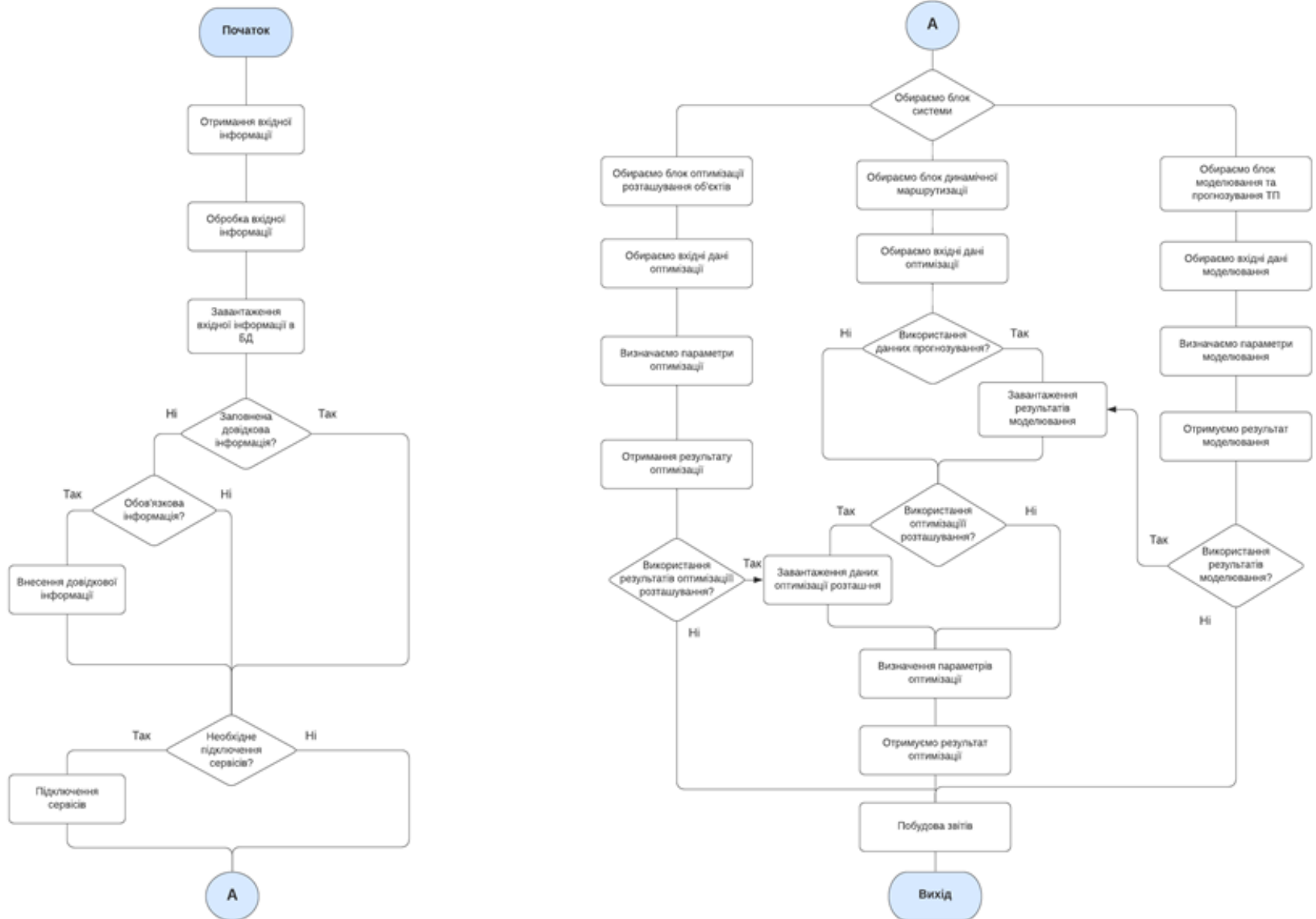
Рисунок 5.3 – Блок-схема роботи алгоритму інформаційної системи підтримки прийняття рішень
