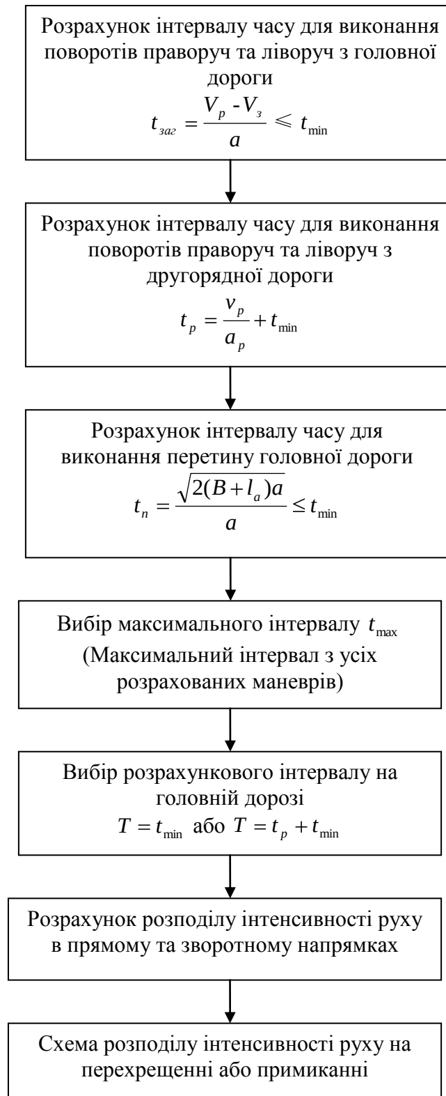
Рисунок 4.3 – Алгоритм розрахунку максимальної інтенсивності руху на перехрещенні або примиканні без перехідно-швидкісних смуг
