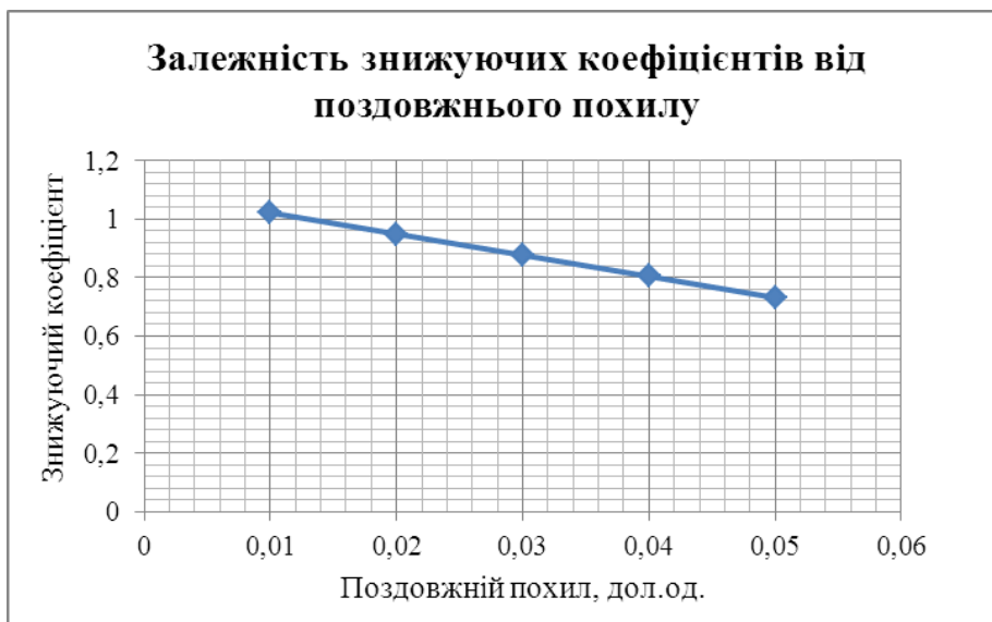
Рисунок Г.7 – Графік залежності понижуючих коефіцієнтів від поздовжнього похилу
