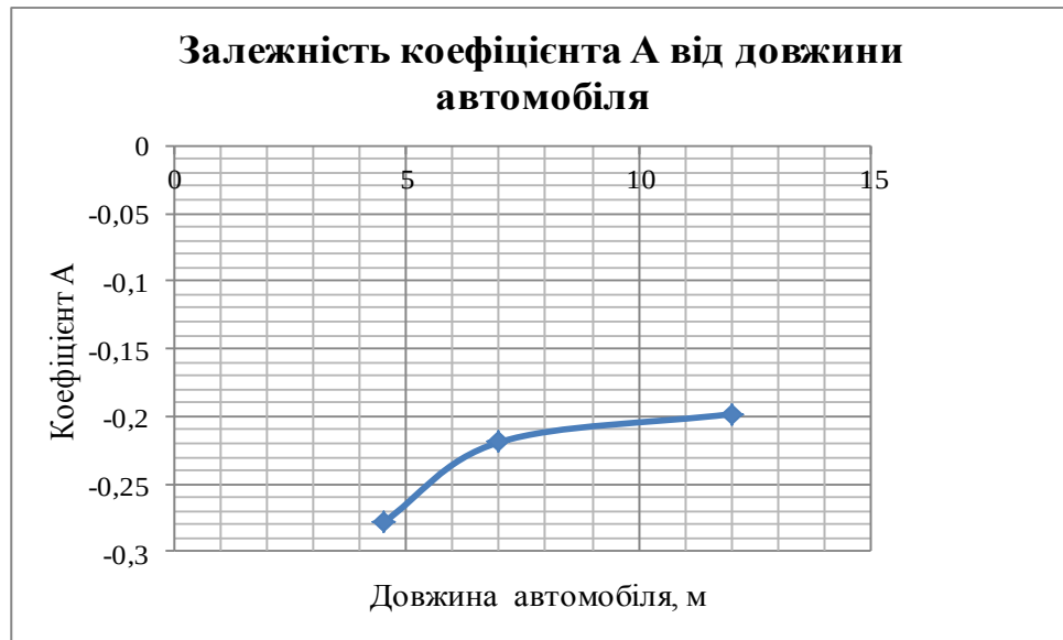
Рисунок Г.1 – Графік залежності коефіцієнта А від середньої довжини автомобіля
