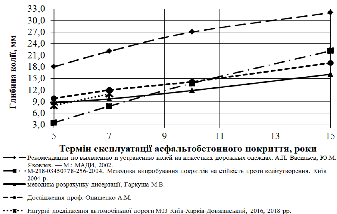
Рисунок 3.82 – Результати розрахунку експериментальної конструкції 3^{21} дорожнього одягу на колійність
