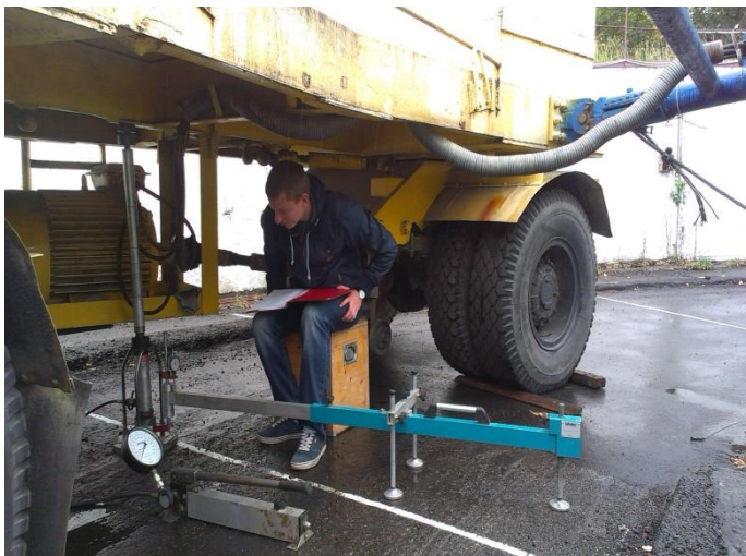
Рисунок 3.59 – Визначення модулів пружності експериментальних конструкцій під жорстким штампом
