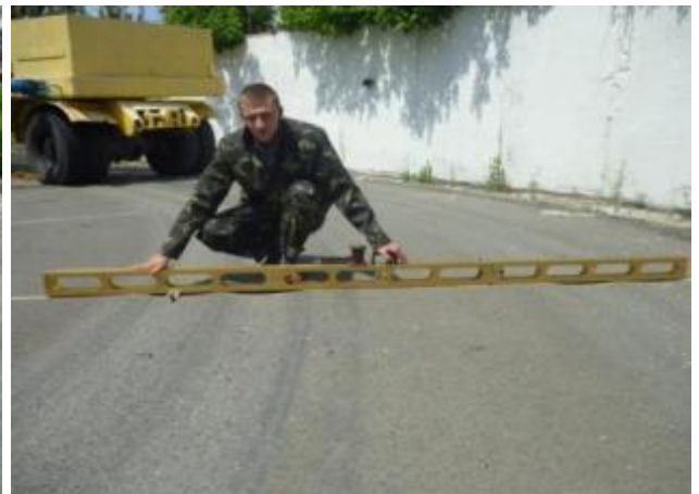
Рисунок 3.52 – Колія, що виникла в конструкції дорожнього одягу на підсекції 3(з укріпленими шарами)
