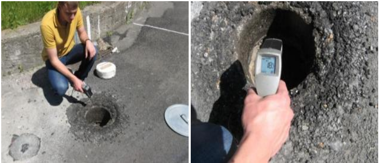
Рисунок 3.60 – Встановлення температурного режиму покриття
