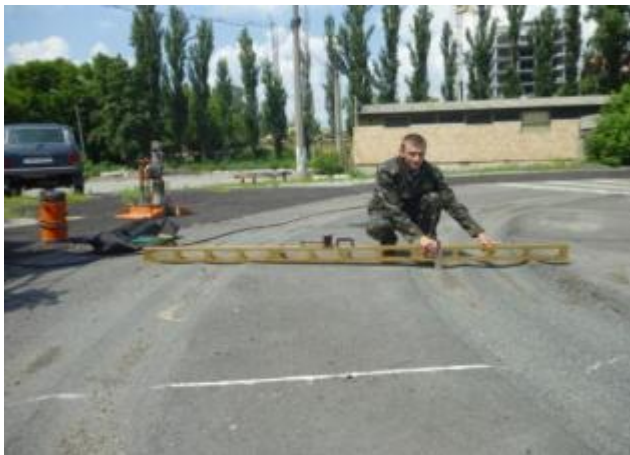
Рисунок 3.51 – Колія, що виникла в конструкції дорожнього одягу на підсекції 1(з неукріпленими шарами)
