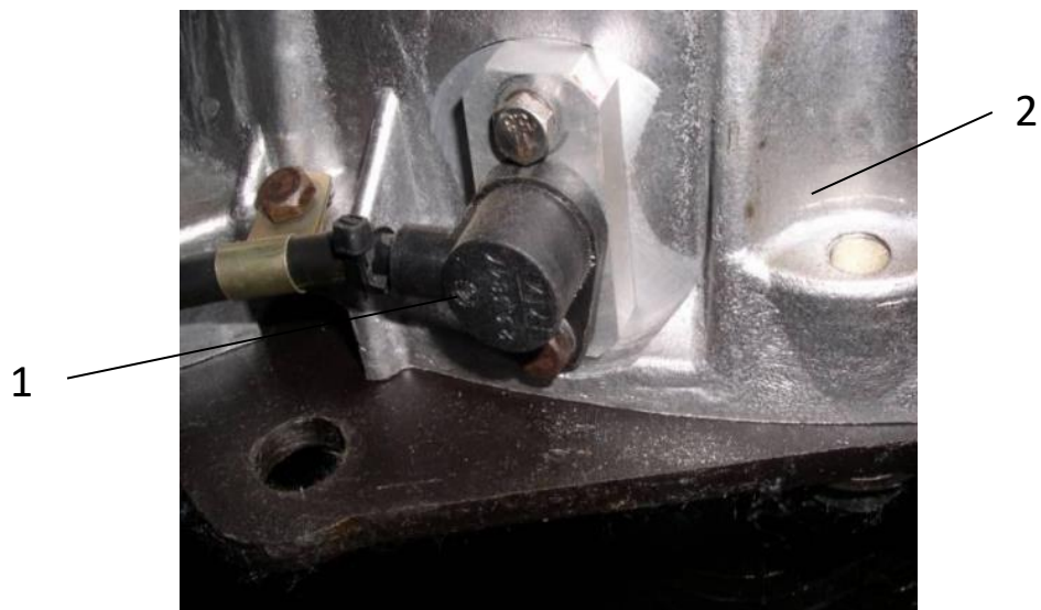
Рисунок 2.7 – Установка датчика частоти обертання колінчастого вала двигуна на картері маховика дизеля Д245.7
