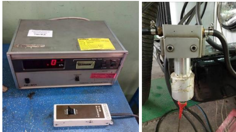
Рисунок 4.8 – Витратомір дизельного палива фірми ONO SOKKI об'ємного типу (датчик та обчислювальний блок)
