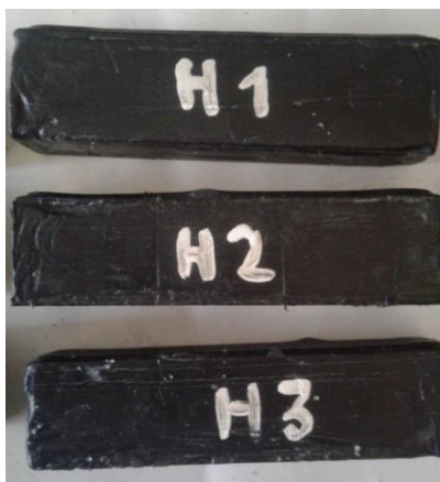
Рисунок 3.4 – Загальний вигляд зразків балочок з герметизуючих матеріалів
