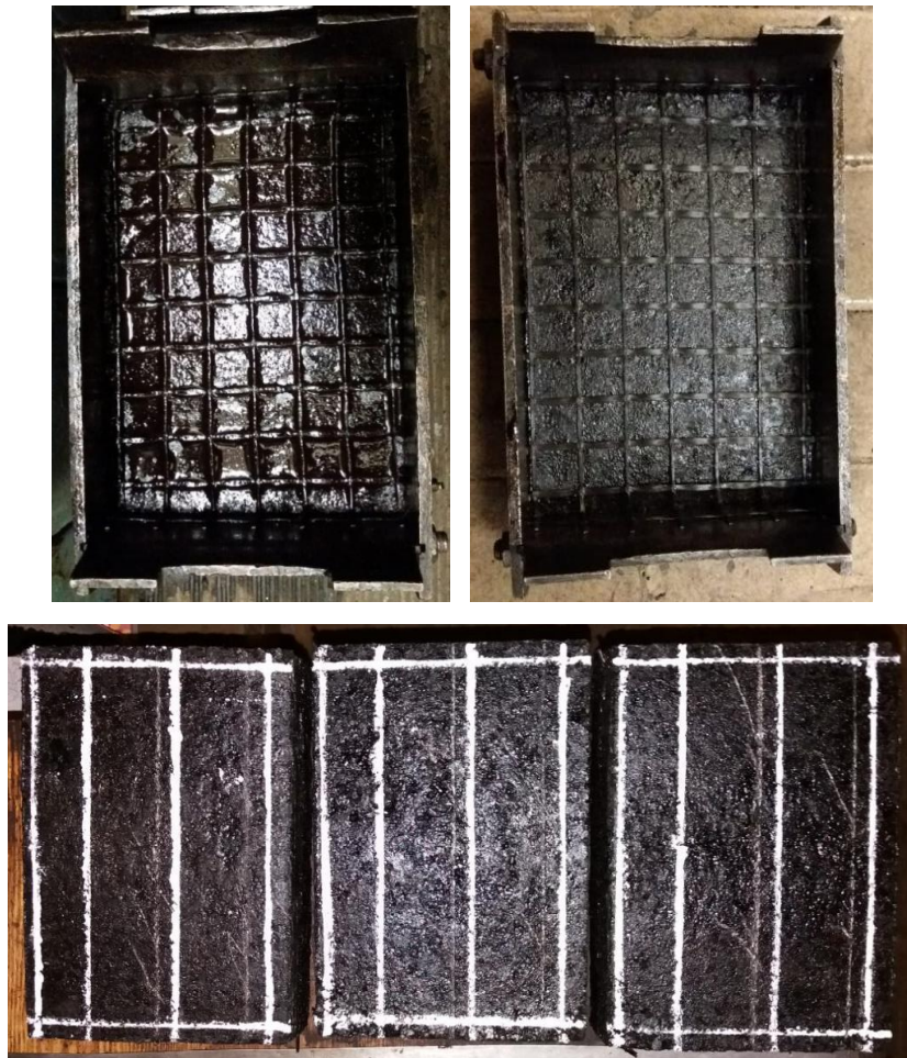
Рисунок 3.10 – Виготовлення розмітка та армованих асфальтобетонних плит
