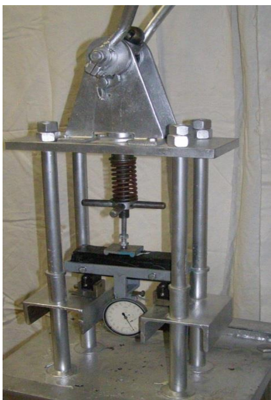
Рисунок 3.5 – Випробування зразків балочок з герметизуючих матеріалів
