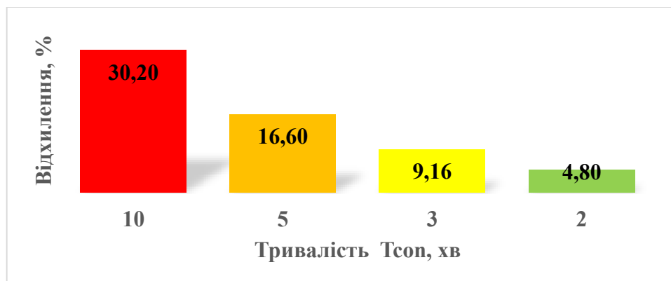
Рисунок 2.6 – Відхилення результатів у відсотках при значеннях тривалості поверхневої концентрації стоку прийнятої за ДБН В.2.5-75:2013
