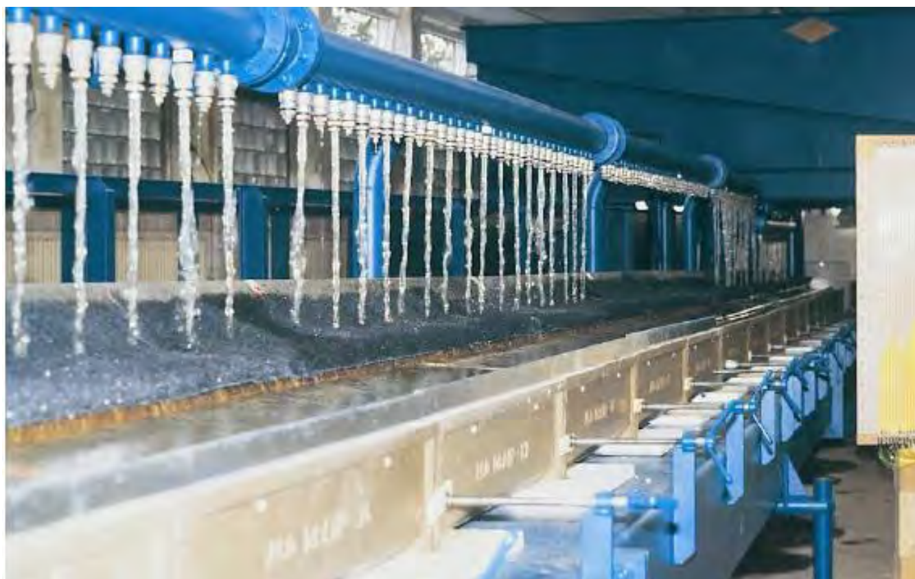
Рисунок 3.3 – Стенд для визначення пропускної здатності водовідвідних каналів
