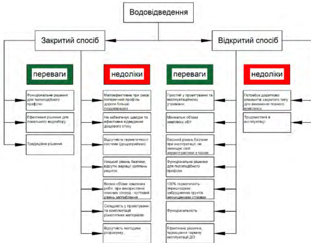
Рисунок 1.3 – Порівняльна характеристика закритого та відкритого способів поверхневого водовідведення
