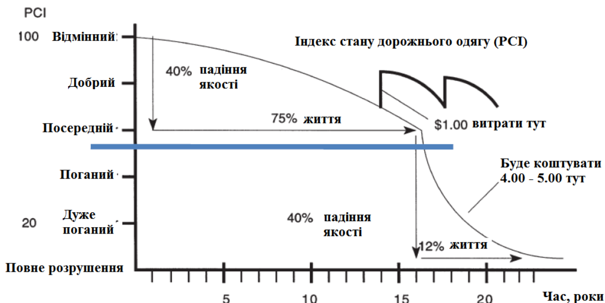
Рисунок 1.1 – Типовий життєвий цикл дорожнього одягу [122]
