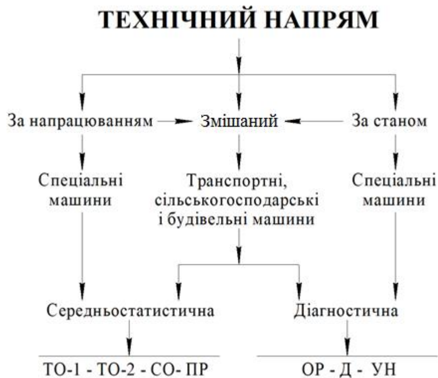
Рисунок 1.3 – Схема організації технічних обслуговувань і ремонтів машин [19].
