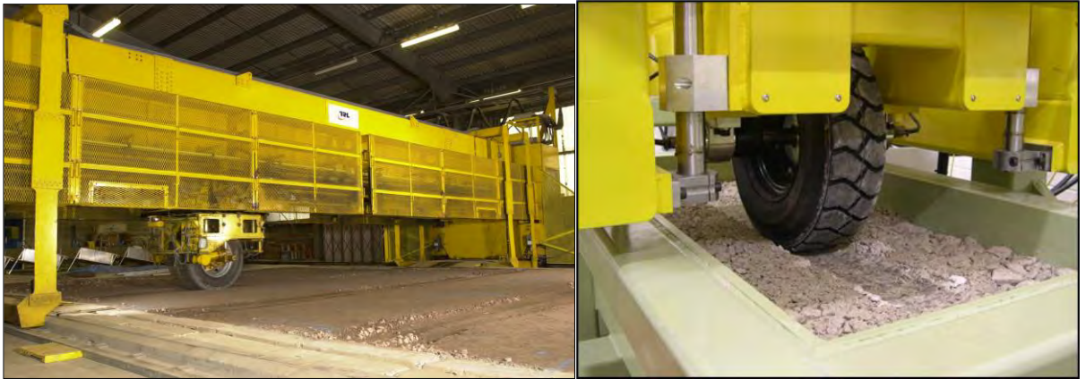
Рисунок 1.5 – Дослідження тривісноорієнтованих геораток Тенсар Лабораторії транспортних досліджень (TRL), Великобританія
