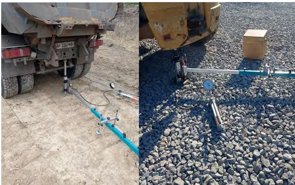
Рисунок 2.2 – Статичні штампові випробування ґрунтової основи та шару із щебеню фр. 20 – 40
