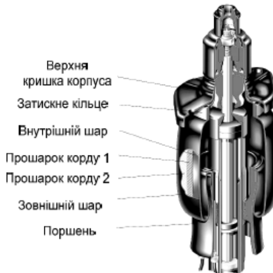
Рисунок 1.4 - Конструктивна схема пневматичного елемента, інтегрованого співвісно з амортизатором
