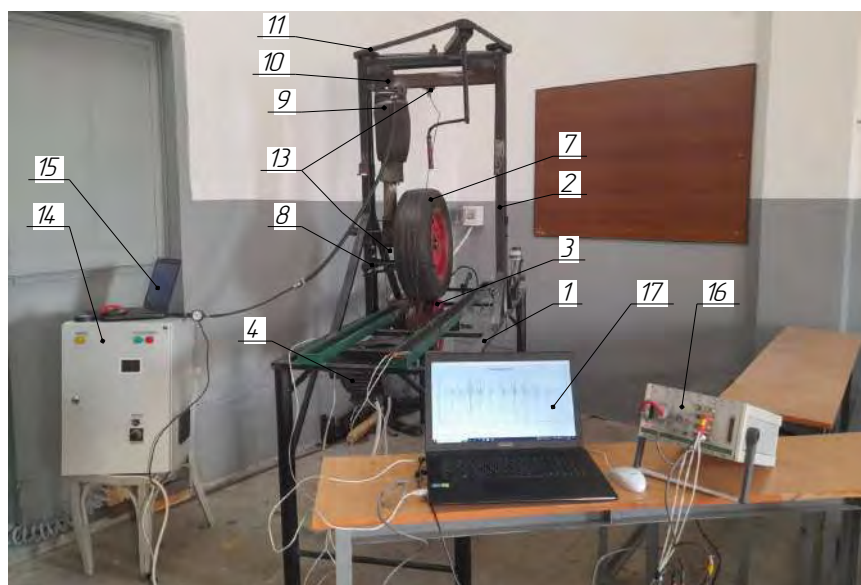
Рисунок 4.1 - Загальний вигляд експериментальної установки для дослідження віброприскорення
