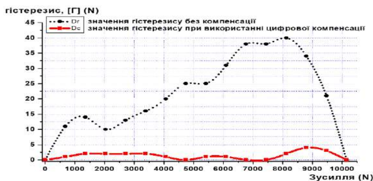
Рисунок 13. Приклад ефективності розробленого методу цифрової компенсації гістерезису
