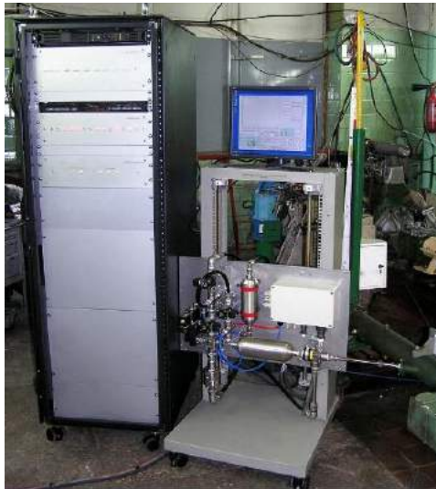
Рисунок 9 – Розроблені система аналізу емісії частинок моделі «MT-010» та спосіб диференційного вимірювання витрати проби відпрацьованих газів
