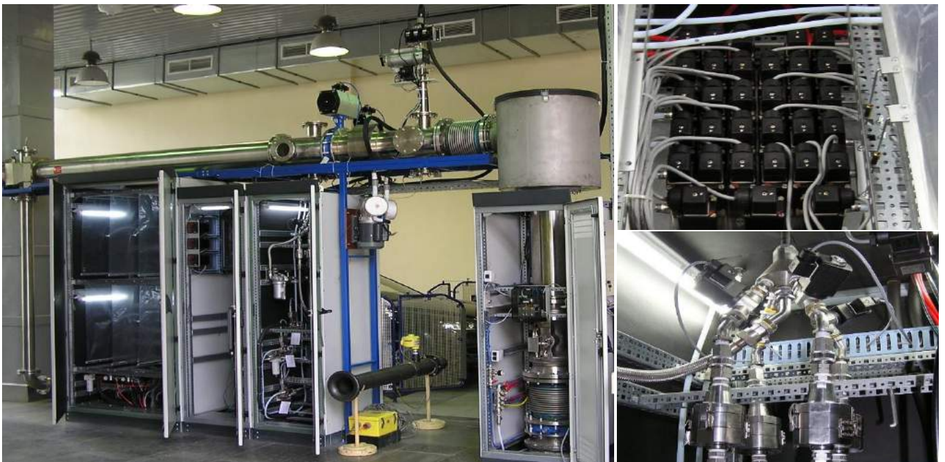
Рисунок 8 – Розроблена система CVS моделі EMMS-CVS-010, яка реалізує також розроблений метод повно-потоківого відбору проб змінного об’єму (метод VVS)
