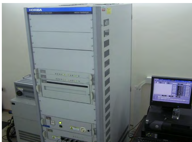
Рисунок А.6.4 – Газоаналітична система MEKA-7400DEGR вимірювання концентрації нормованих забруднюючих речовин у газах при роботі з вітчизняною системою EMMS-CVS-010 Рисунок А.6.5 – Генератор газових сумішей SGD-710C для прецизійного розведення ПГС
