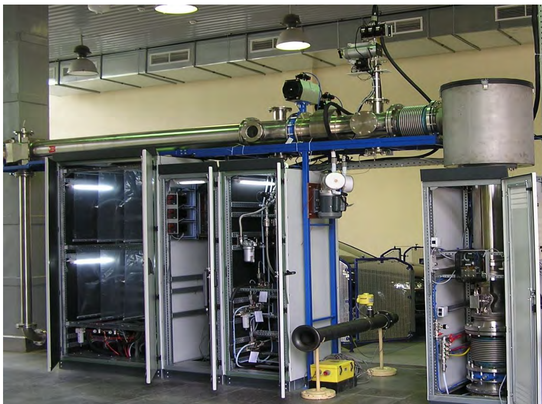
Рисунок А.6.1 – Загальний вигляд основної частини елементів вітчизняної системи CVS моделі EMMS-CVS-010
