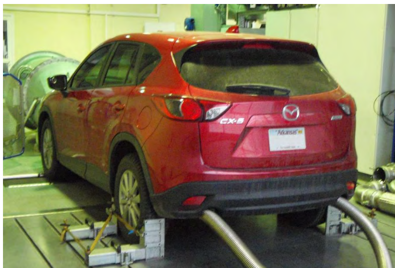
Рисунок А12.6 – Фотографія (приклад) КТЗ, встановленого на роликовому моделюючому стенді з під'єднаною системою відбору газів
