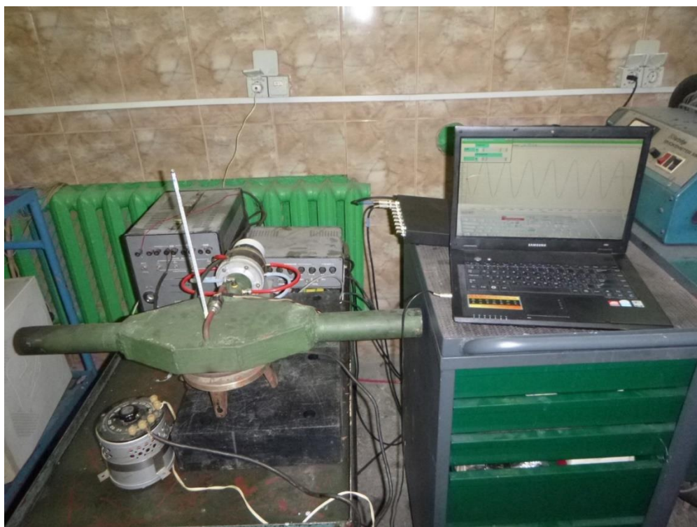
Рисунок 3.14 – Зовнішній вигляд вимірювальної установки для визначення калібрувальної залежності та оцінювання похибки фазоакустичного датчика температури
