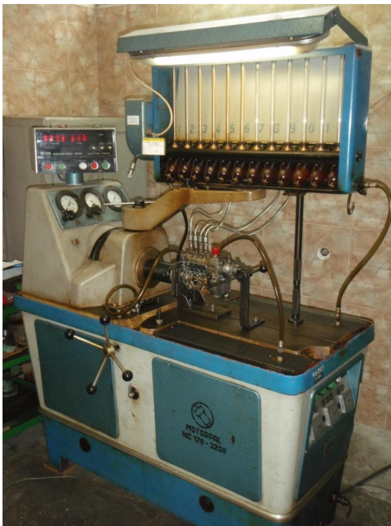
Рисунок 4.13 – Стенд для перевірки та регулювання ПНВТ дизелів Motorpal NC-128
