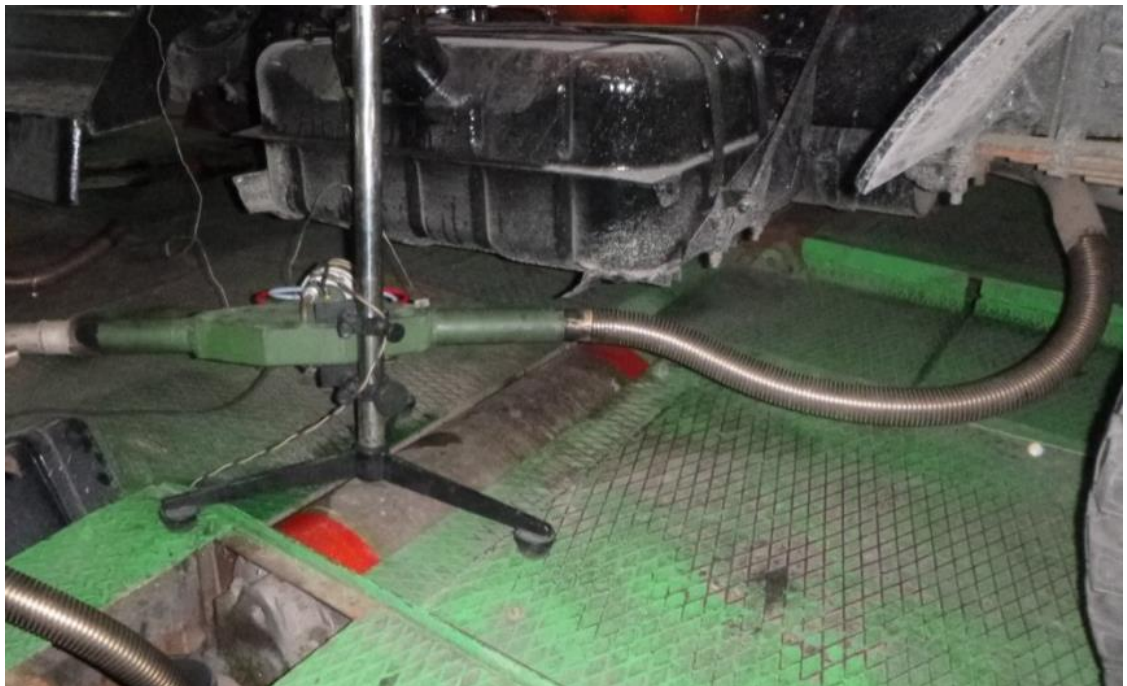
Рисунок 4.50 - Макетний зразок ФАДТ з ПАРК підключений до випускної труби КТЗ
