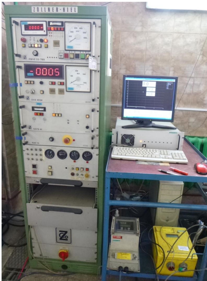
Рисунок 4.5 – Шафа керування та система збору даних стенду Zöllner
