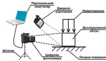
Рис. 13 Схема застосування методу цифрової кореляції зображень при випробуванні бетонних призм
