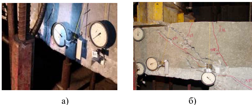
Рисунок 3.56 – Характер руйнувань плит ПМ–3 (1),
