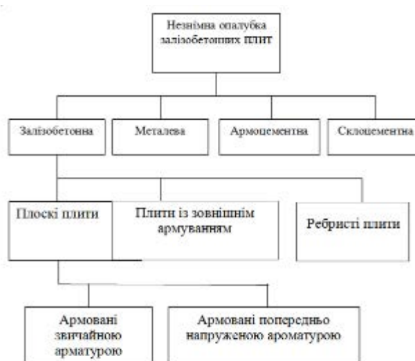
Рисунок 1.1 – Класифікація незнімних опалубок
