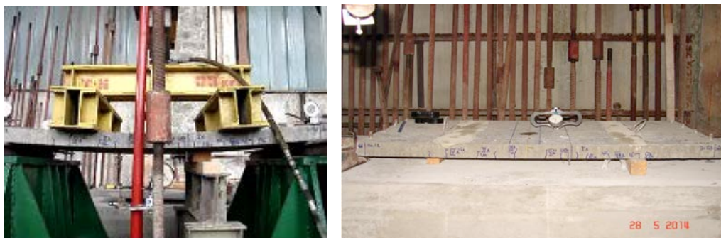
Рисунок 3.32 – Характер руйнувань плити ПО–2,
