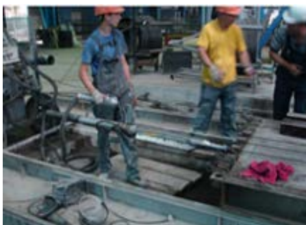
Рисунок 3.14 – Натягування арматурних канатів К–7 гідравлічним домкратом
