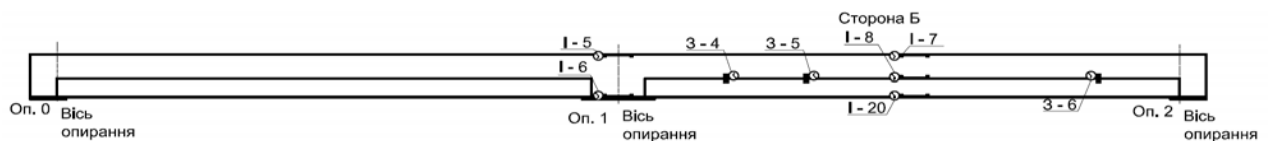
Рисунок 3.68 – Схема розміщення приладів на зразку ПМ-5 та ПМ-5,
