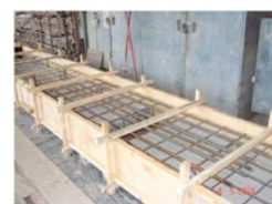
Рисунок 3.26 – Армування зразка плити ПМ–5
