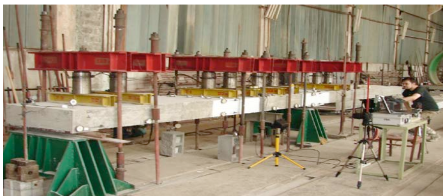
Рисунок 3.62 – Загальний вигляд випробувальної установки для зразків залізобетонних плит проїзної частини ПМ–4
