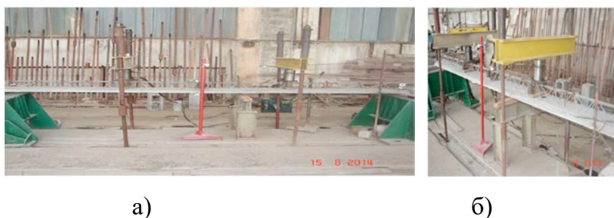
Рисунок 3.38 – Загальний вигляд станку для випробування плит незнімної опалубки ПО-4,
