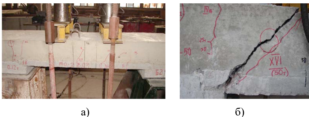
Рисунок 3.52 – Характер руйнувань плит ПМ–2 (1)
