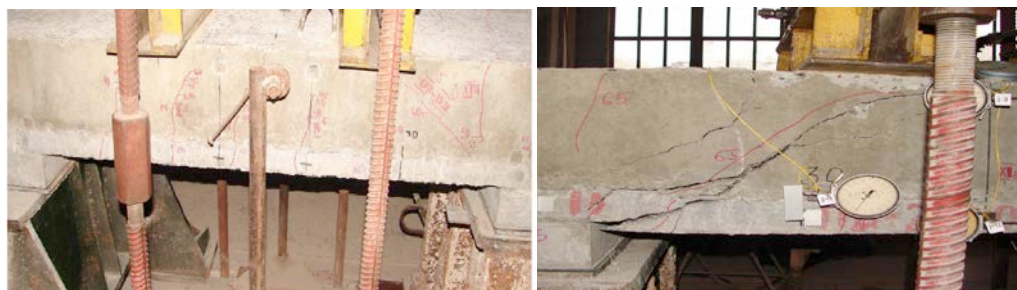
Рисунок 3.54 – Характер руйнувань плит ПМ–2 (2),
