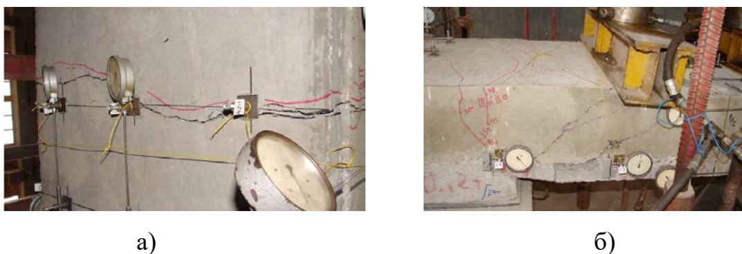
Рисунок 3.58 – Характер руйнувань плит ПМ-3 (2),
