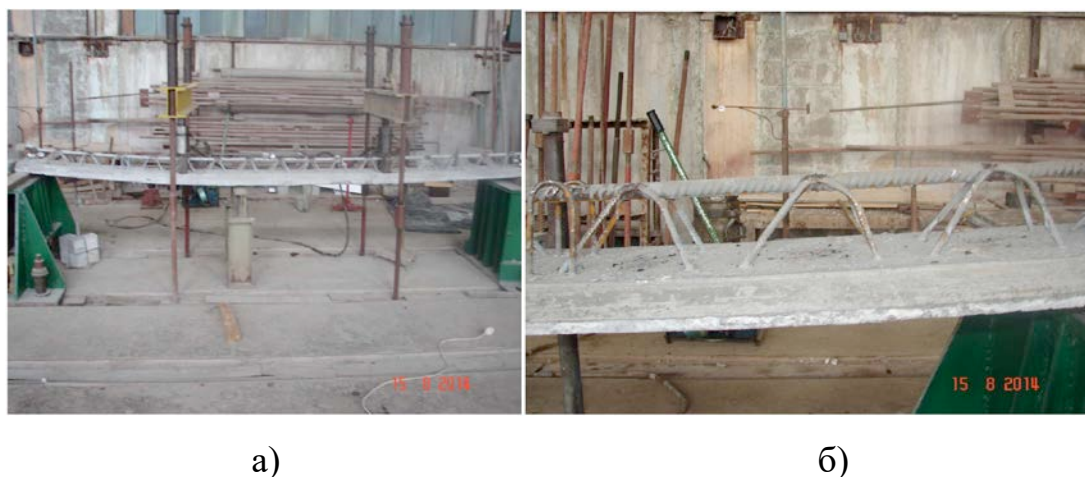
Рисунок 3.39 – Характер руйнування плит ПО–4
