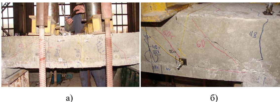
Рисунок 3.47 – Характер руйнувань плит ПМ–1 (2)
