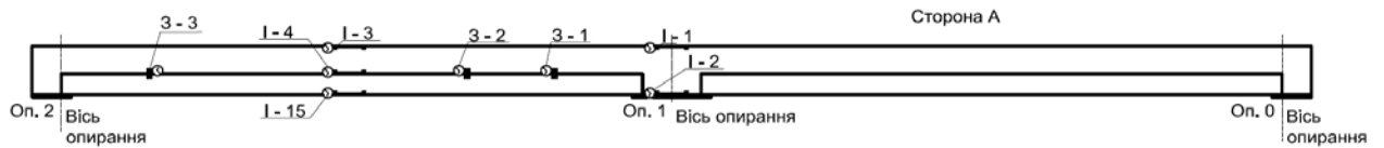
Рисунок 3.67 – Схема розміщення приладів на зразках ПМ-5* та ПМ-5,
