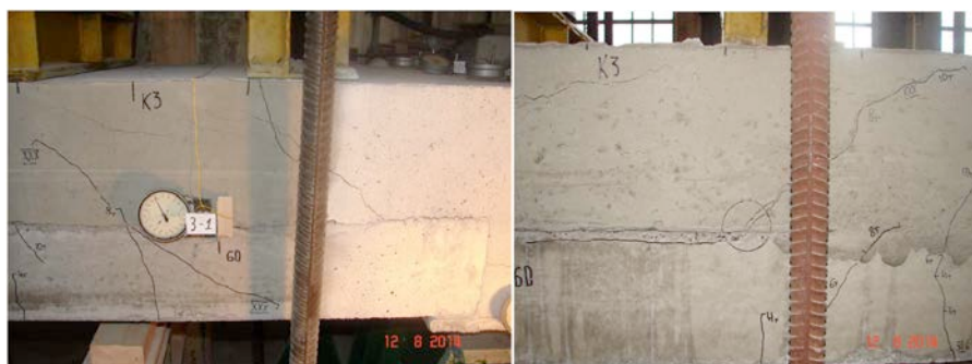
Рисунок 3.70 – Характер руйнування зразків серії ПМ–5:
