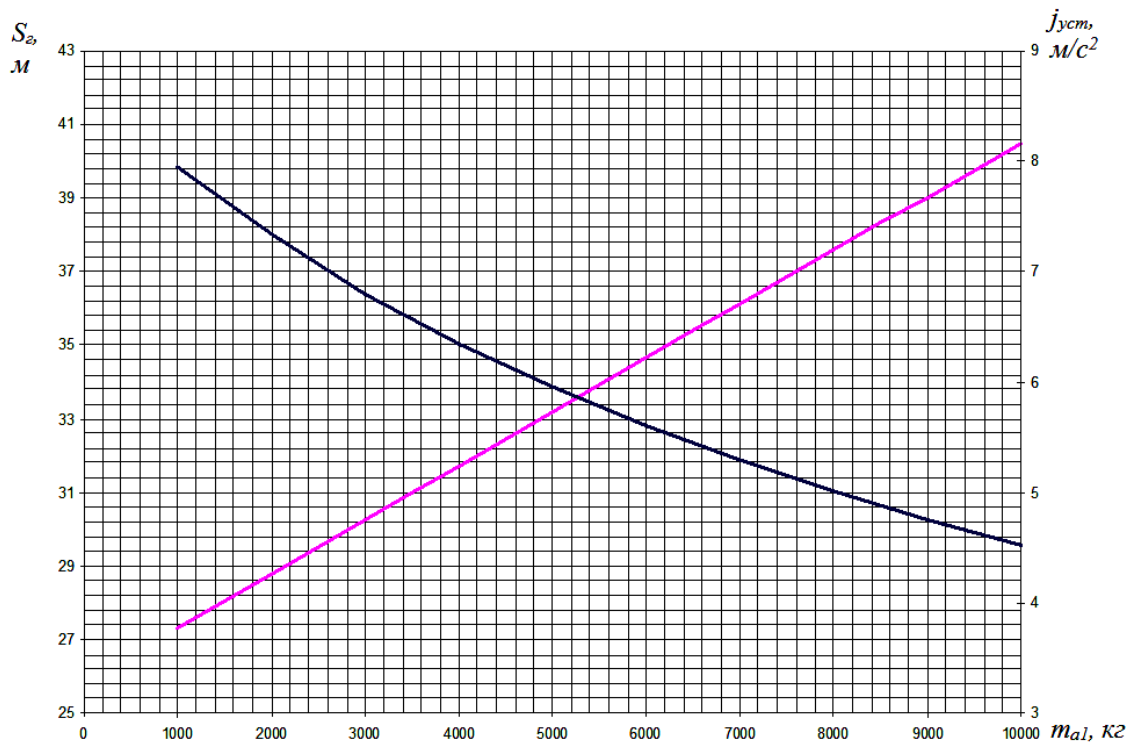
Рис. 3.3 - Залежність гальмівного шляху і усталеного сповільнення КТЗ від розподілу маси по осям (КТЗ з двигуном, від'єднаним від трансмісії)
