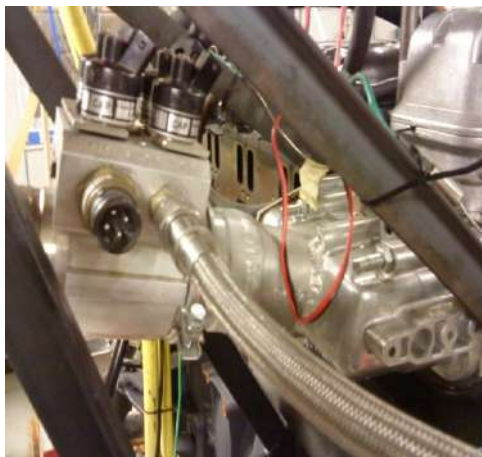
Рисунок 3.7 – Блок-змішувач паливоповітряної суміші з електромагнітними форсунками
