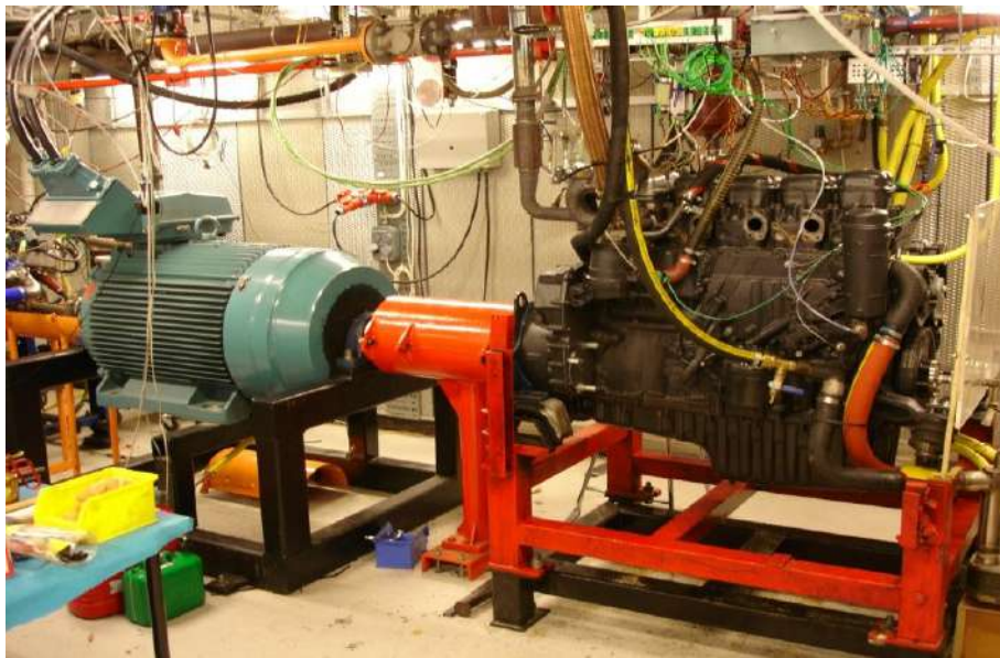
Рисунок 3.6 – Лабораторна установка для дослідження двигуна Scania
