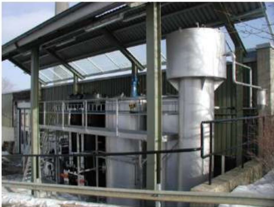
Рисунок 2.20 – Експериментальна установка для досліджень виходу газу із різних видів біомаси
