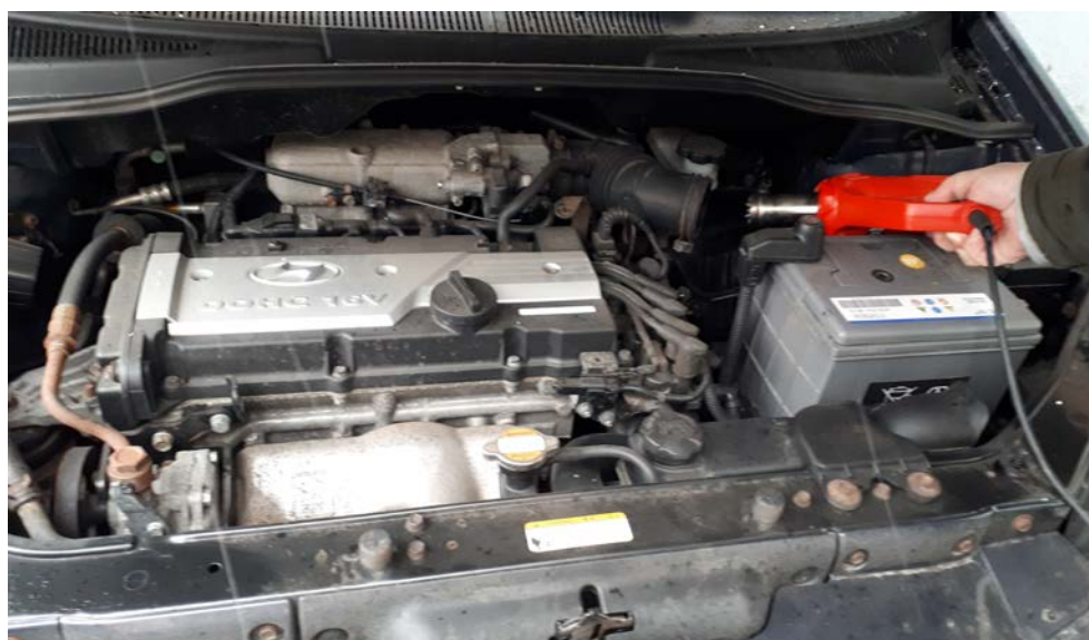
Рисунок 4.27 – Спосіб підведення теплоти для додаткового підігрівання впускного повітря
