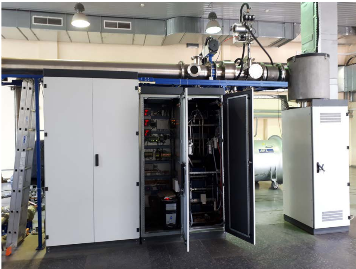
Рисунок 4.3 – Загальний вигляд та обладнання системи CVS (Constant Volume Sampling)
