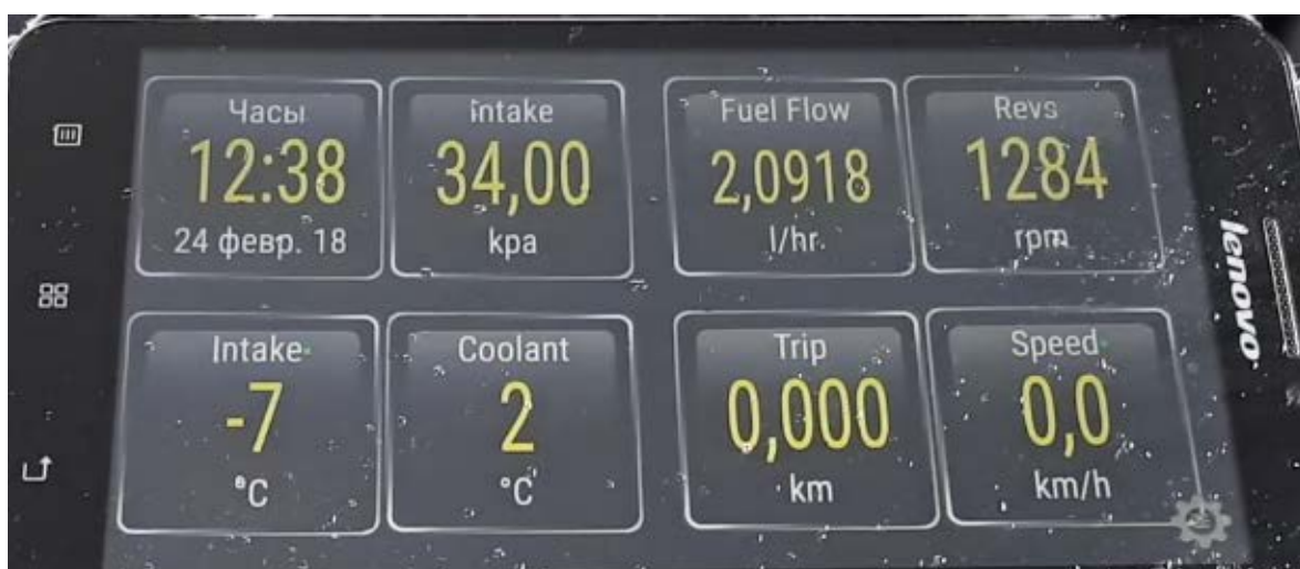
Рисунок 4.10 – Виведення параметрів поточного діагностування блоку управління двигуном
