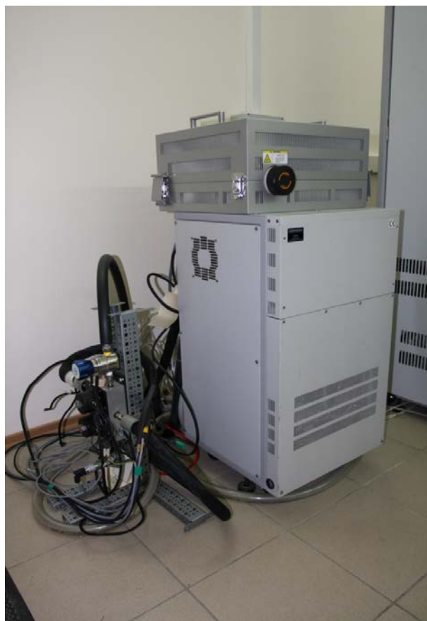
Рисунок 4.7 – Газоаналізуючий комплекс МЕХА-7400DEGR
