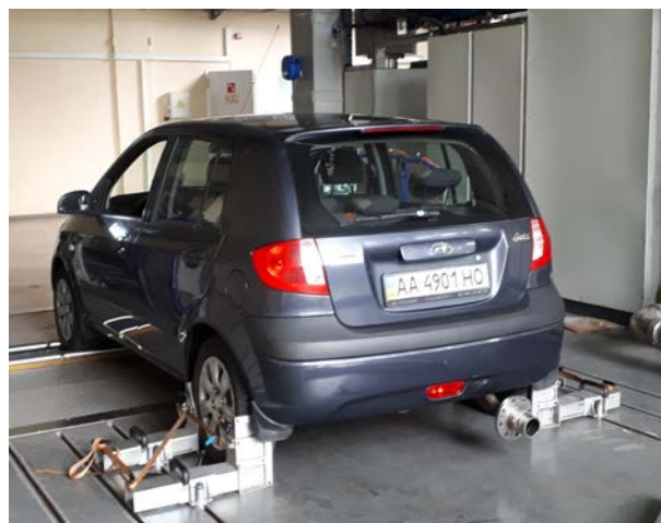
Рисунок 4.4 – Закріплення автомобіля на стенді AVL-Zollner з біговими барабанами
