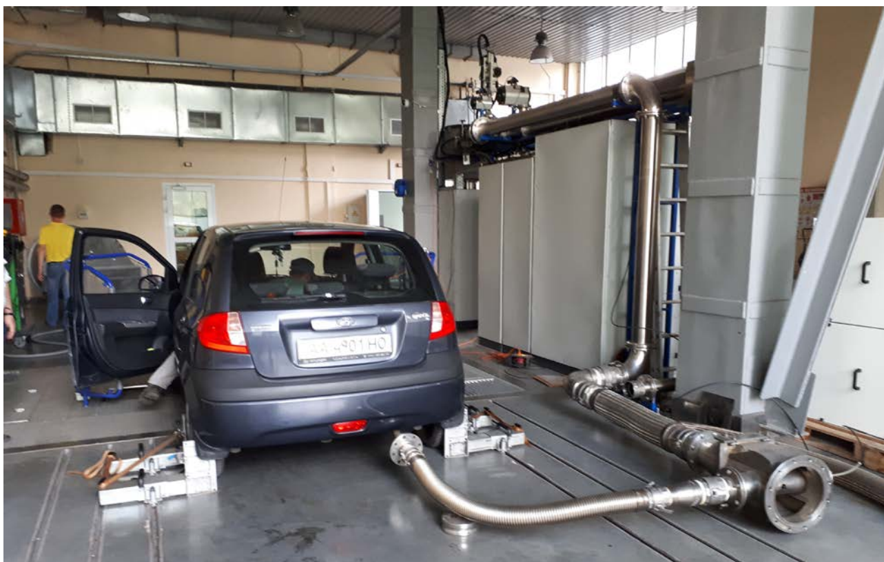
Рисунок 4.5 – Під'єднання автомобіля до тунелю для відбору відпрацьованих газів
