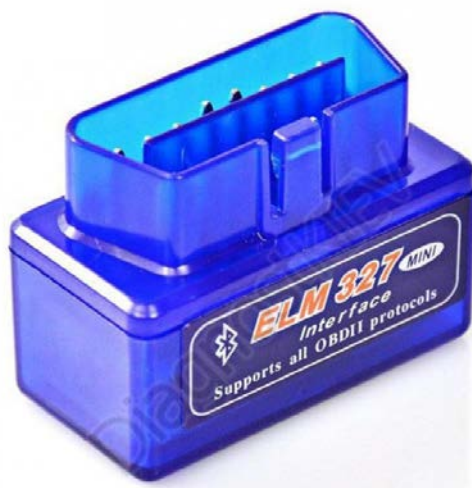
Рисунок 4.9 – Діагностичний адаптер ELM-327
