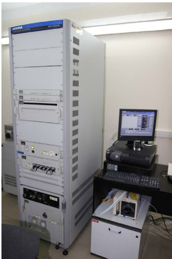
Рисунок 4.7 – Газоаналізуючий комплекс МЕХА-7400DEGR
