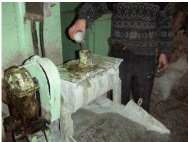
Рисунок Д.5 – Заливання піноконцентрату в піногенератор
