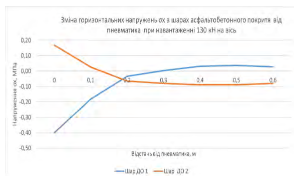
Рисунок Б.30 - Зміна напружень в шарах асфальтобетонного покриття від пневматика осі 4 при навантаженні 130 кН для конструкції ДО12458, схеми №3 щодо розташування пневматика по відношенню до перехідної плити: а - для горизонтальних напружень \sigma_x ; б - для дотичних напружень \tau_{xz}
