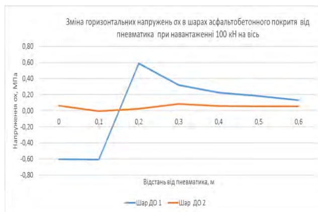
Рисунок Б.32 – Зміна горизонтальних гальмівних напружень \sigma_x в шарах асфальтобетонного покриття від пневматика осі 4 при навантаженні 100 кН для конструкції ДО1258, схеми №3 щодо розташування пневматика по відношенню до перехідної плити
