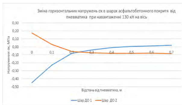
Рисунок Б.29 – Зміна напружень в шарах асфальтобетонного покриття від пневматика осі 3 при навантаженні 130 кН для конструкції ДО12458, схеми №3 щодо розташування пневматика по відношенню до перехідної плити: а – для горизонтальних напружень \sigma_x ; б – для дотичних напружень \tau_{xz}
