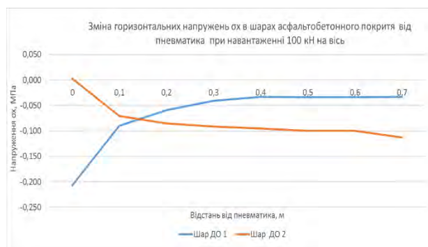
Рисунок Б.38 - Зміна напружень в шарах асфальтобетонного покриття при гальмуванні від пневматика осі 3 при навантаженні 100 кН для конструкції ДО1248, схеми №3 щодо розташування пневматика по відношенню до перехідної плити: а - для горизонтальних напружень \sigma_x ; б - для дотичних напружень \tau_{xz}
