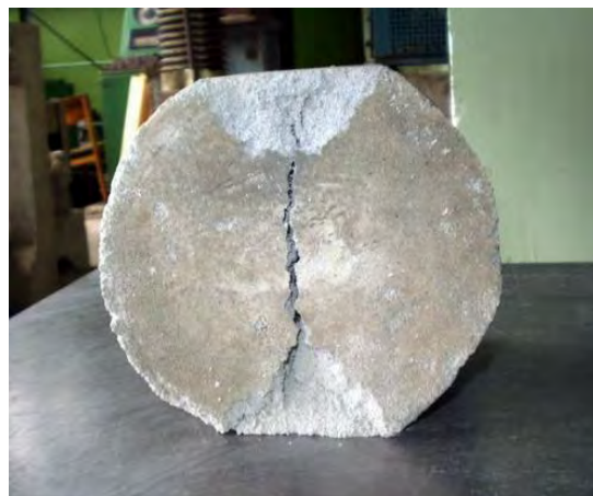
Рисунок Д.9 – Зовнішній вигляд зразка-циліндра після руйнування.
