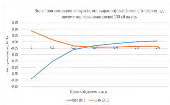
Рисунок Б.44 - Зміна напружень в шарах асфальтобетонного покриття при гальмуванні від пневматика осі 4 при навантаженні 130 кН для конструкції ДО1248, схеми №4 щодо розташування пневматика по відношенню до перехідної плити: а - для горизонтальних напружень \sigma_x ; б - для дотичних напружень \tau_{xz}
