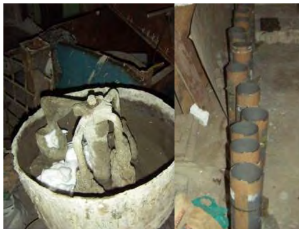
Рисунок Д.6 – Бетономішалка об'ємом 20 л, з вертикально розташованим валом та пластмасові форми-циліндри висотою 650 мм і діаметром 100 мм.
