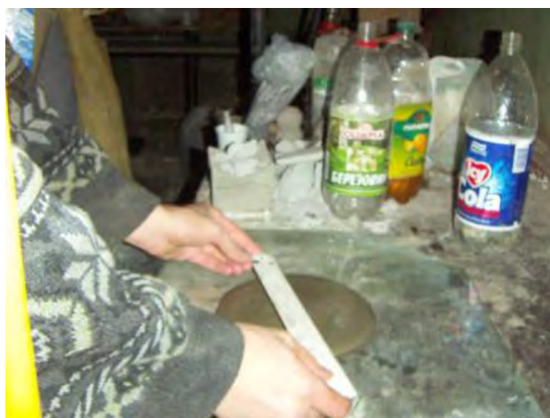
Рисунок Д.7 – Визначення водопотреби суміші розчину по діаметру розпливу розчину
