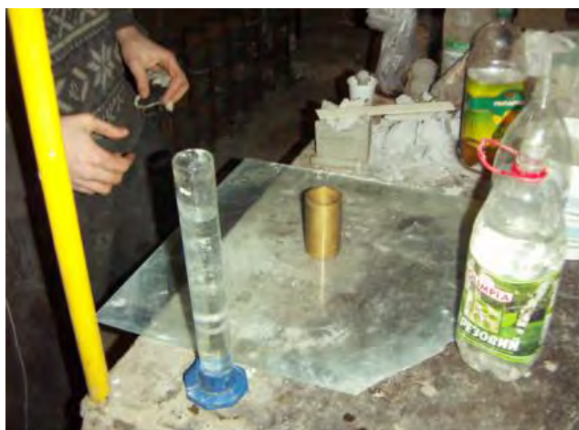
Рисунок Д.7 – Визначення водопотреби суміші розчину по діаметру розпливу розчину
