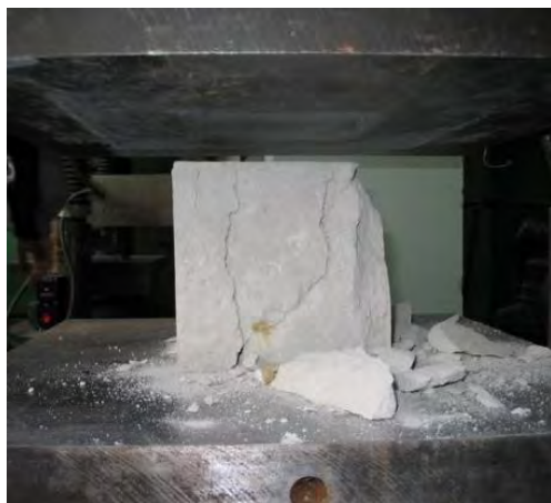
Рисунок Д.8 – Зовнішній вигляд зразків-кубиків після руйнування.
