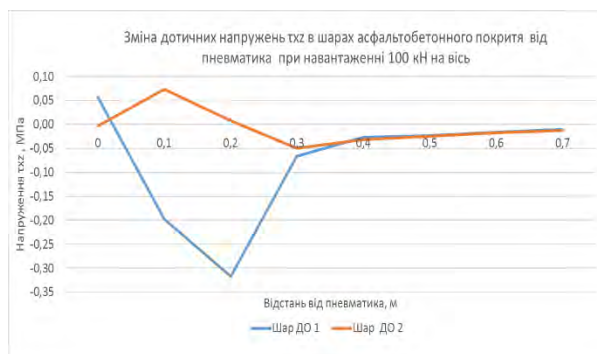
Рисунок Б.39 - Зміна напружень в шарах асфальтобетонного покриття при гальмуванні від пневматика осі 4 при навантаженні 100 кН для конструкції ДО1248, схеми №3 щодо розташування пневматика по відношенню до перехідної плити: а - для горизонтальних напружень \sigma_x ; б - для дотичних напружень \tau_{xz}
