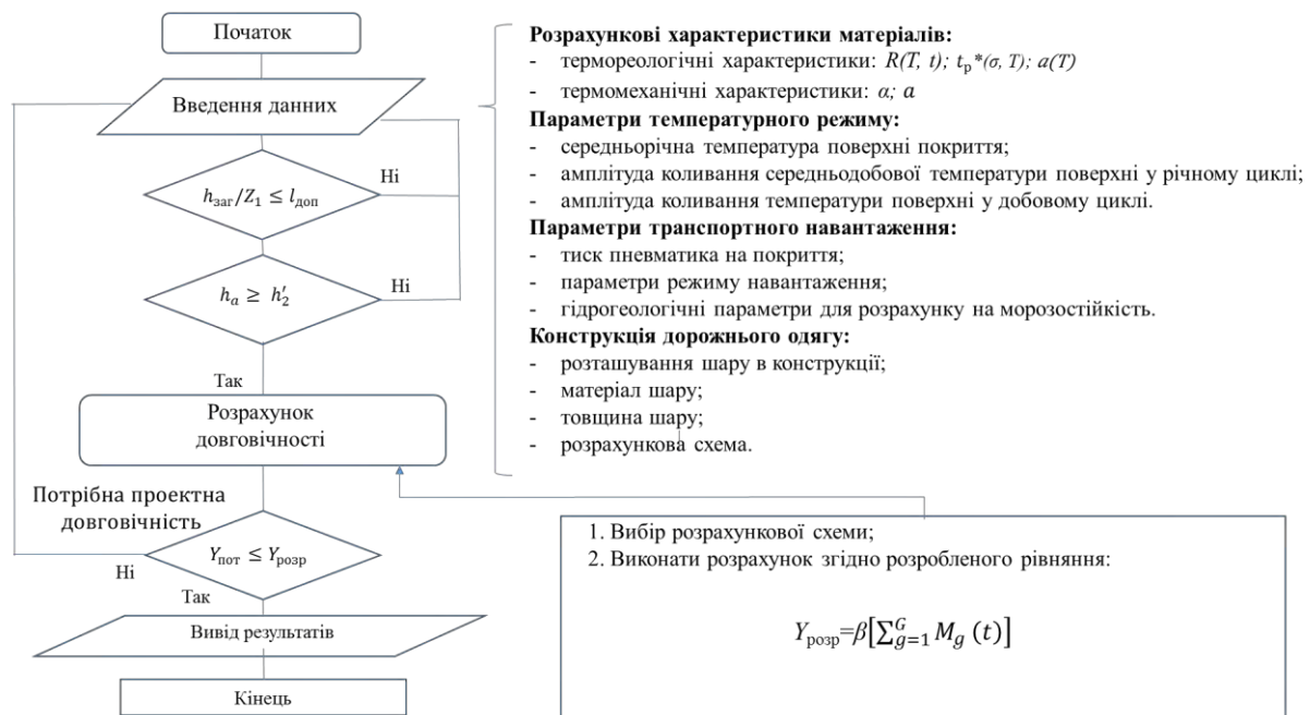
Рисунок 4.1 – Алгоритм розрахунку довговічності асфальтобетонного покриття на підходах до автодорожніх мостів
