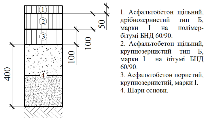
Рисунок 5 – Конструкція дорожнього одягу, на якій влаштовано карти з армованими асфальтобетонними шарами підсилення
