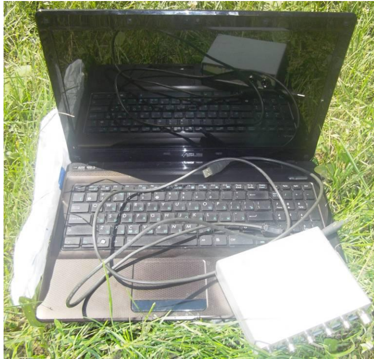
Рисунок 4.3 – Вимірювальний комплекс, на базі USB-осцилографа, ПК
