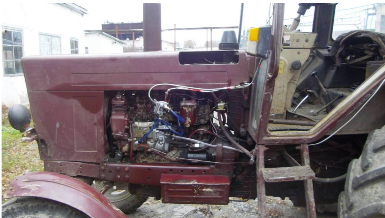
Рисунок 4.2 – Дизель Д-241, встановлений на тракторі МТЗ-80
