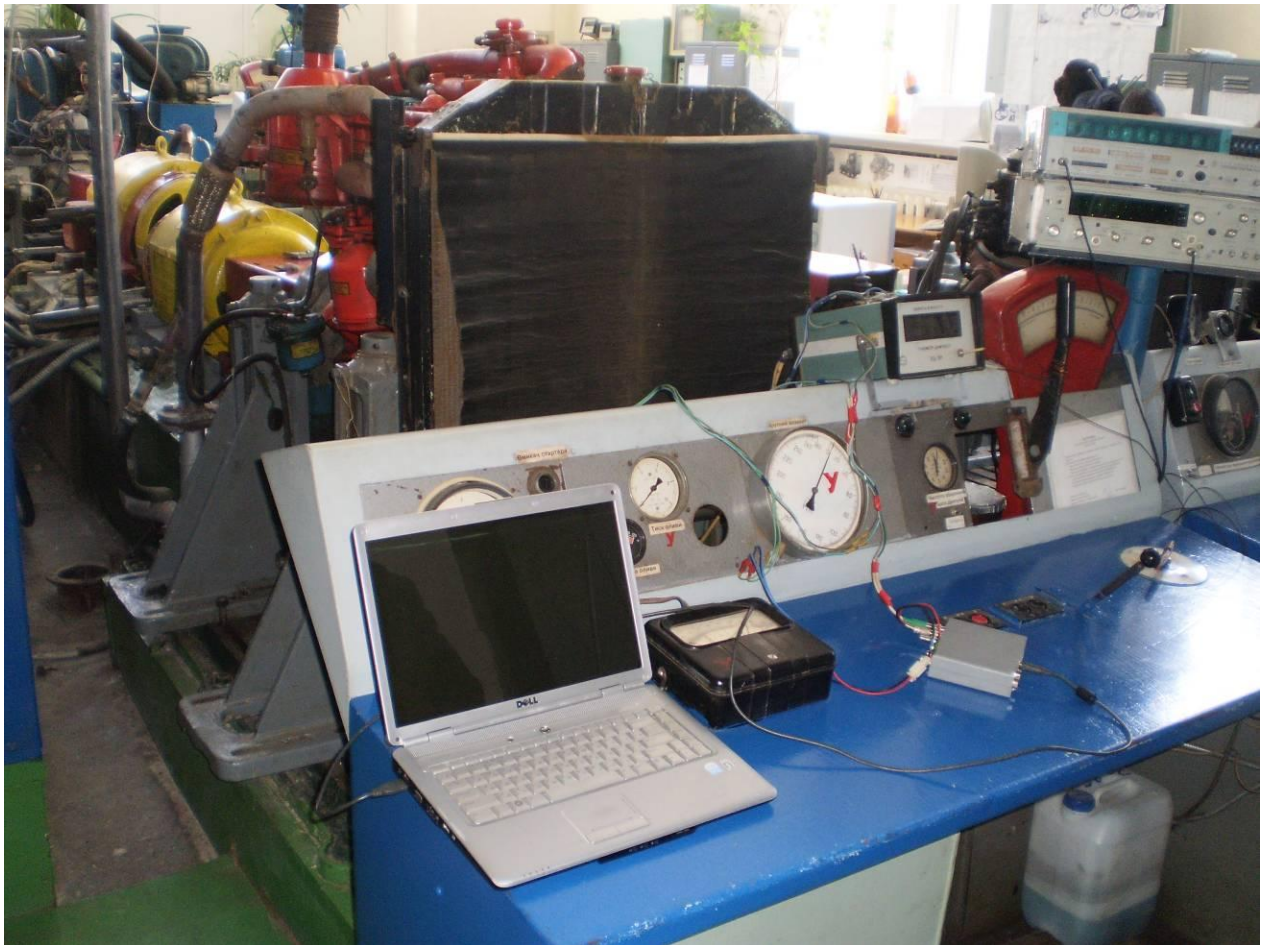
Рисунок 3.2 – Вимірювальний комплекс, який включає USB-Oscilloscope, ПК
