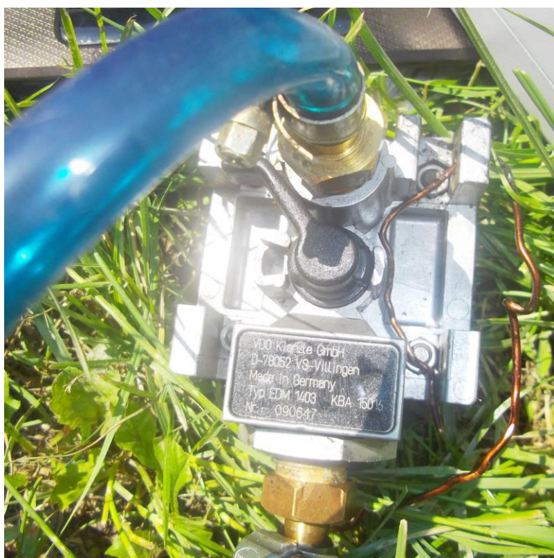
Рисунок 4.4 – Зовнішній вид об'ємного витратоміра палива EDM 1403
