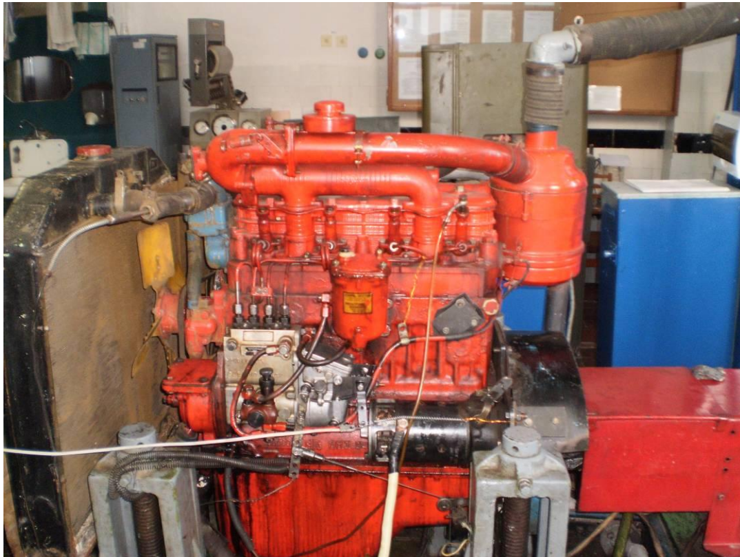
Рисунок 3.3 - Двигун Д-241 на моторному стенді
