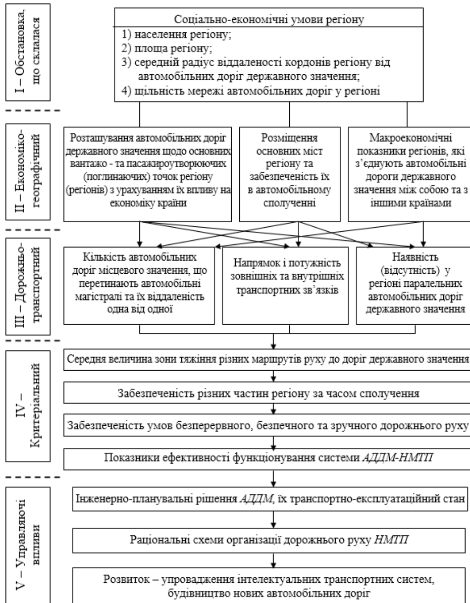
Рисунок 3 – Формалізована схема функціонування транспортної системи регіону АДДМ-НМТП
