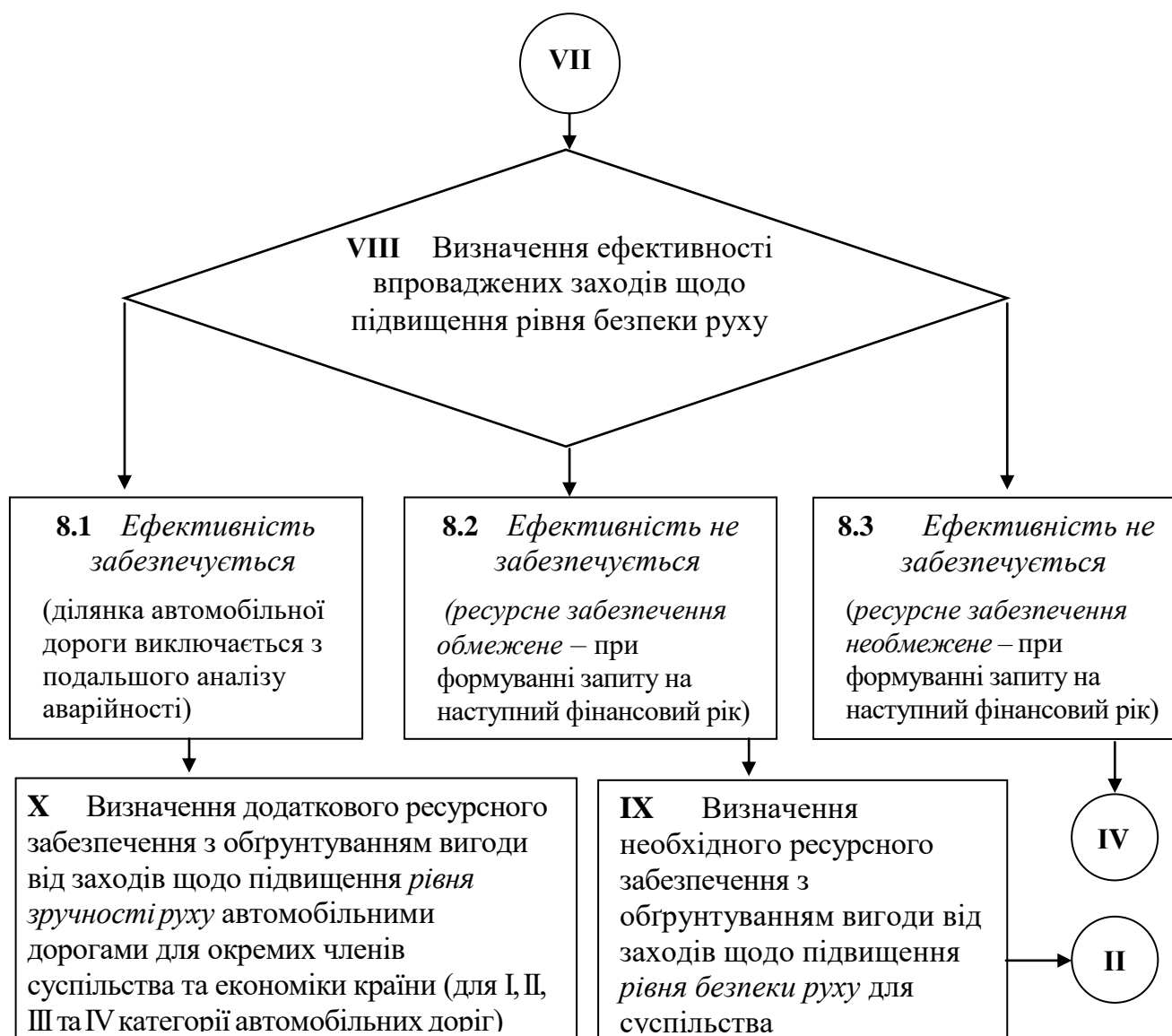
Рисунок 5.10 - Алгоритм визначення рівнів безпеки руху транспортних потоків автомобільними дорогами
