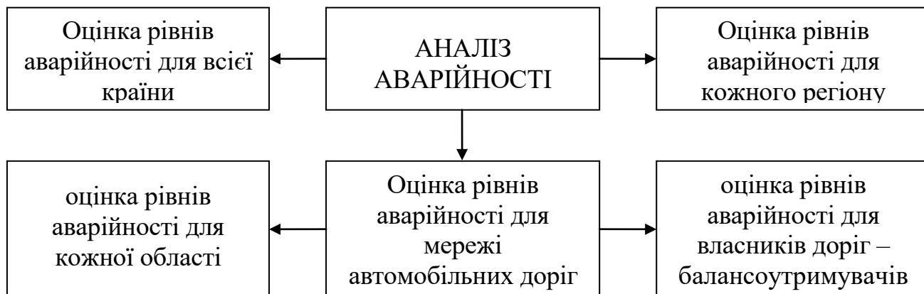
Рисунок 5.8 - Блок-схема аналізу аварійності на автомобільних дорогах України
