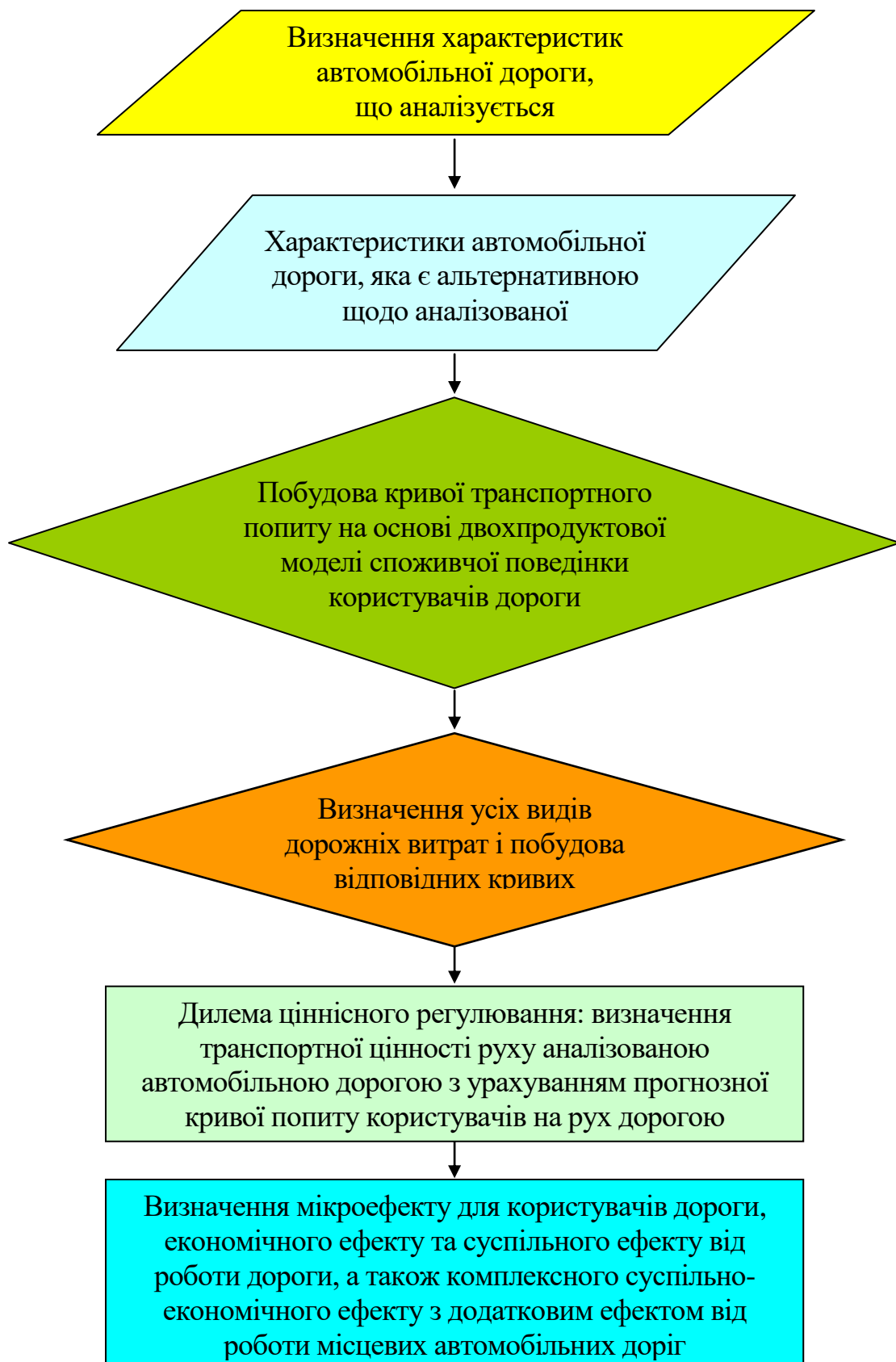
Рисунок 3.13 – Алгоритм оцінки ефективності роботи автомобільної дороги через визначення транспортної цінності забезпечення умов зручного руху
