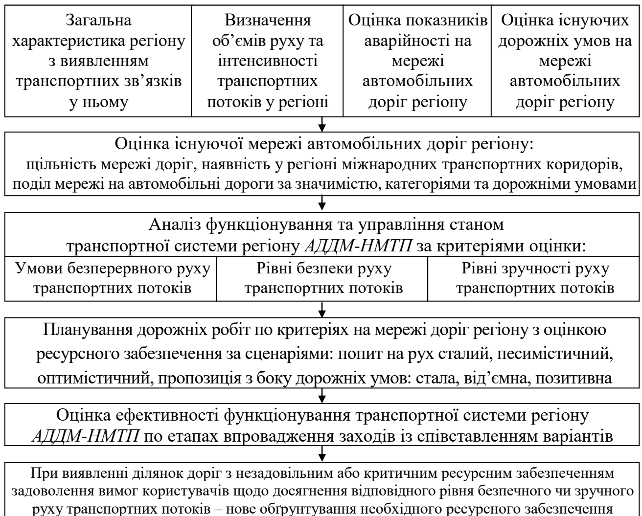
Рисунок 5.7 - Загальний алгоритм оцінки ефективності функціонування та управління станом транспортної системи регіону АДДМ-НМТП
