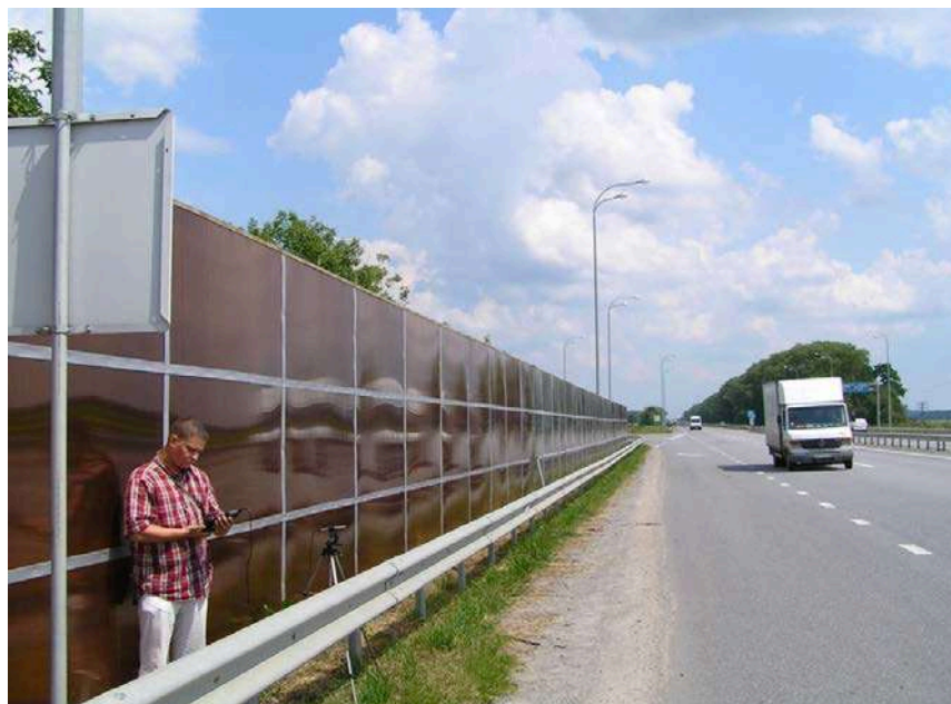
Рисунок 3.2 – Вимірювання транспортного шуму перед шумозахисним екраном на 238 км автомобільної дороги Київ-Чоп
