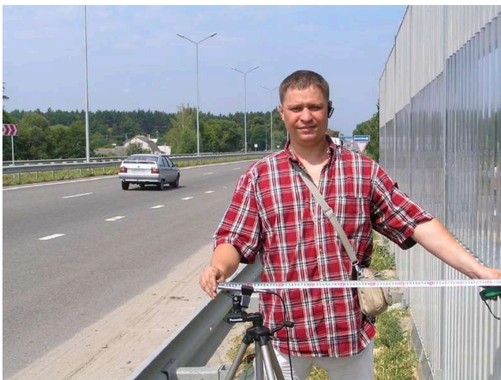
Рисунок 3.4 – Вимірювання транспортного шуму перед ШЗЕ на 157 км автомобільної дороги Київ-Чоп (с. Березівка)
