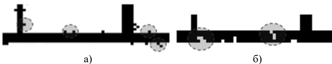
Рисунок 2.25 - Фрагменти контуру деталі, що уражені чорною (а) і білою (б) контурною «бахромою»
