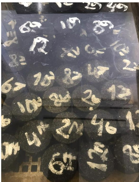
Рисунок 3.7 – Загальний вид зразків під час термостатування зразків за температури 50 °C та 0 °C
