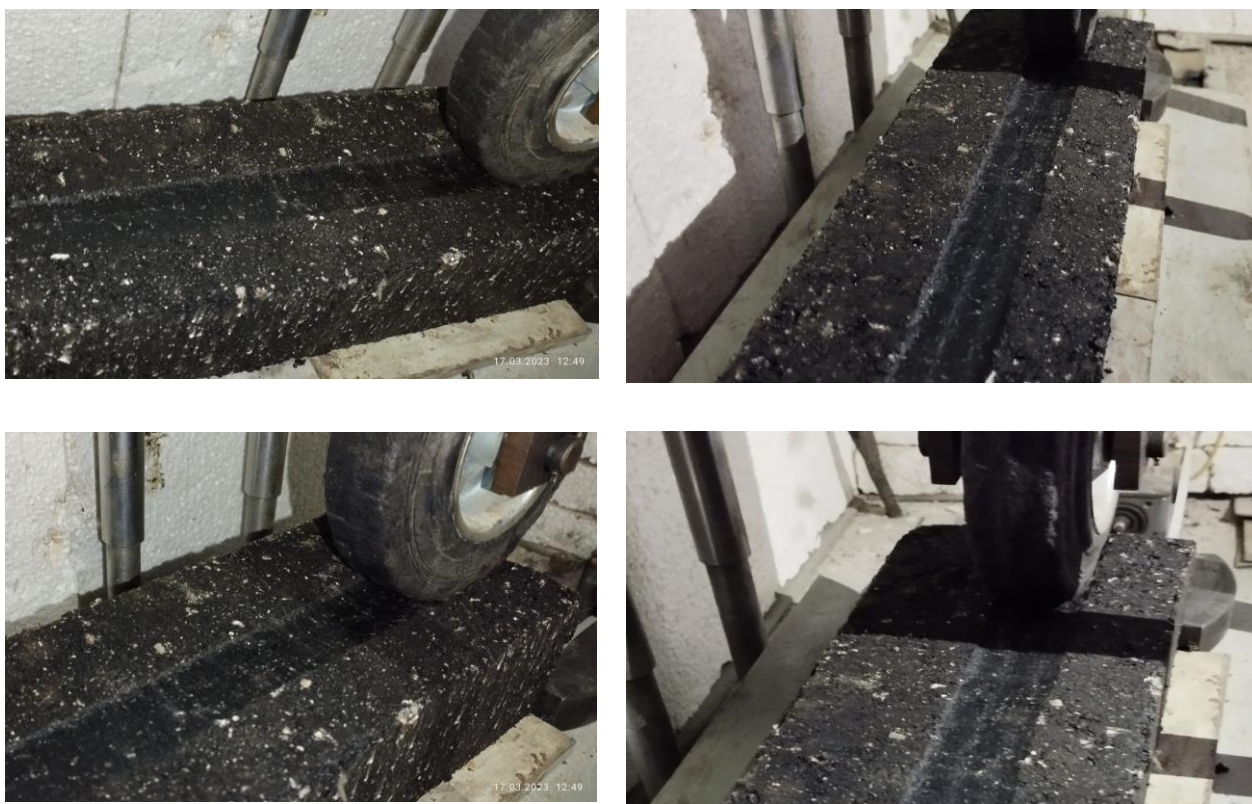
Рисунок 3.15 – Процес проведення випробування на стійкість асфальтобетону до утворення колії
