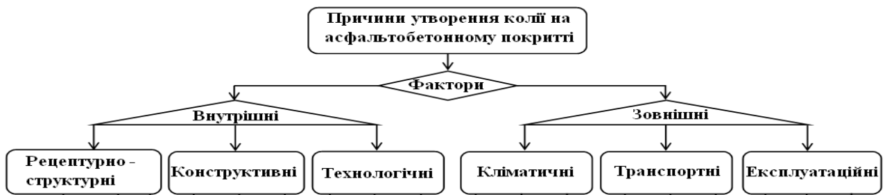
Рисунок 1 – Схема основних факторів і причин утворення колії на асфальтобетонному покритті автодорожніх мостів із залізобетонною плитою проїзної частини
