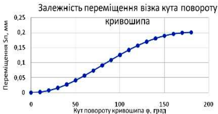
Рисунок Б.11 – Зміна переміщення візка в залежності від кута повороту кривошипа
