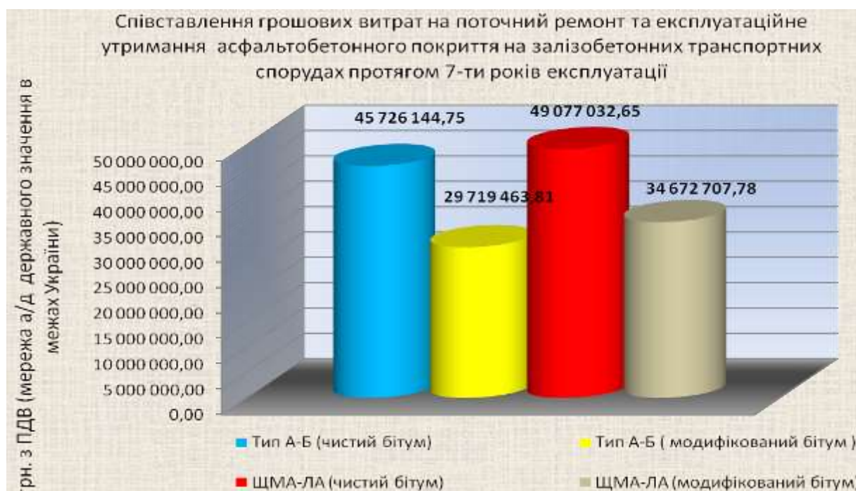
Рисунок Д.1 – Співвідношення грошових витрат на поточний ремонт та експлуатаційне утримання асфальтобетонного покриття на залізобетонних транспортних спорудах
