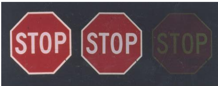
Рисунок 3.1 – Зразки знаків через 1 рік експлуатації (ліворуч та у центрі – знак із новою плівкою LG, праворуч – знак із плівкою старого «інженерного» зразка)
