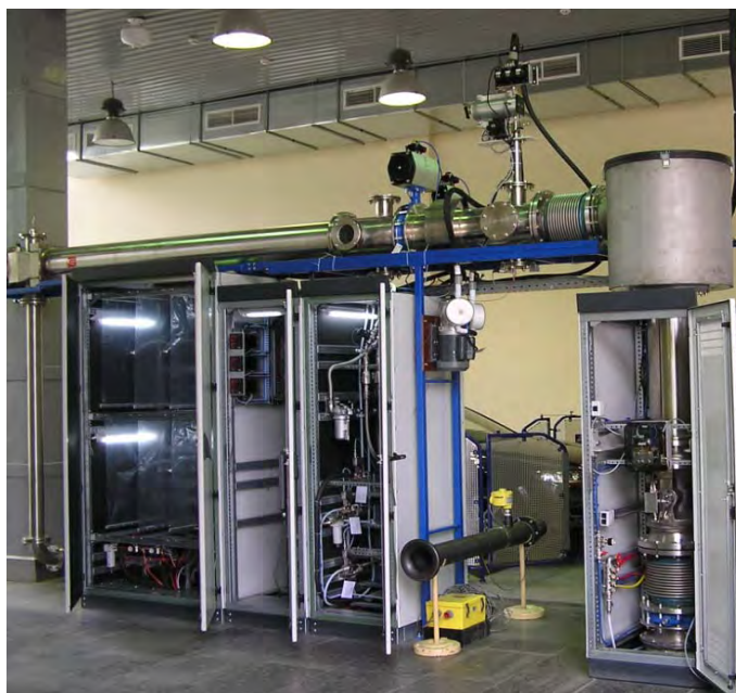
Рисунок 4.9 – Дослідна повно-поточкова система відбору проб на основі універсальної системи відбору проб постійного об'єму (CVS) моделі EMMS-CVS-010, розробленої ДП "ДЕРЖАВТОТРАНСНДПРОЕКТ".
