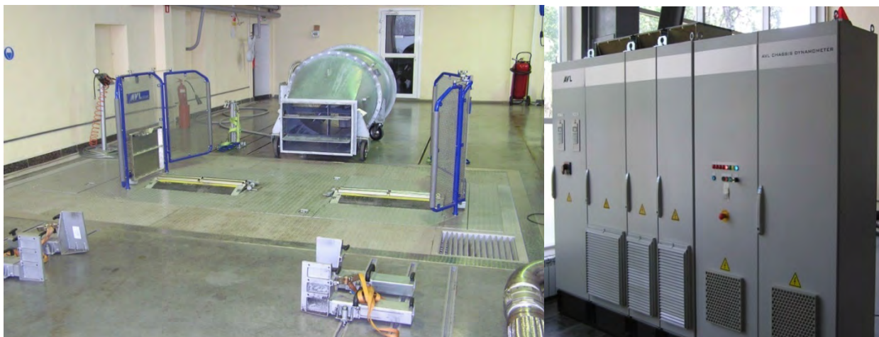
Рисунок 4.7 – Стенд моделюючий роликовий AVL тип RPL1220/12C23M17/APM150 і шафи управління стендом.
