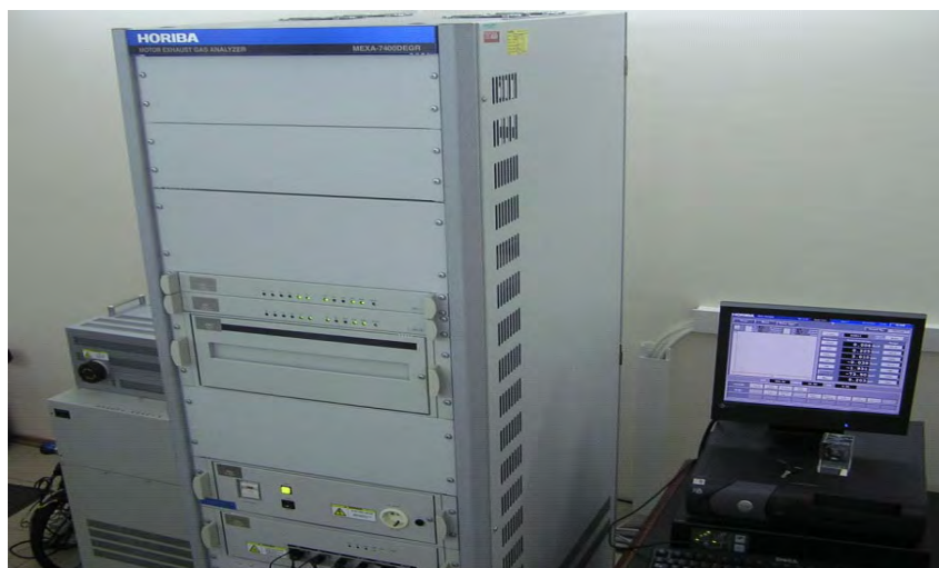
Рисунок 4.8 – Газоаналітична система MEXA-7400DEGR вимірювання концентрації нормованих забруднюючих речовин у газах.
