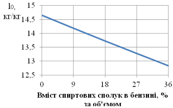
Рисунок 2.2 – Розрахункова залежність теоретично необхідної кількості повітря для згорання 1 кг палива від вмісту добавки спиртових сполук у бензині
