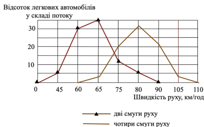
Рисунок 1.1 – Графік розподілення величин миттєвих швидкостей руху при вільному русі легкових автомобілів на дорозі [31].
