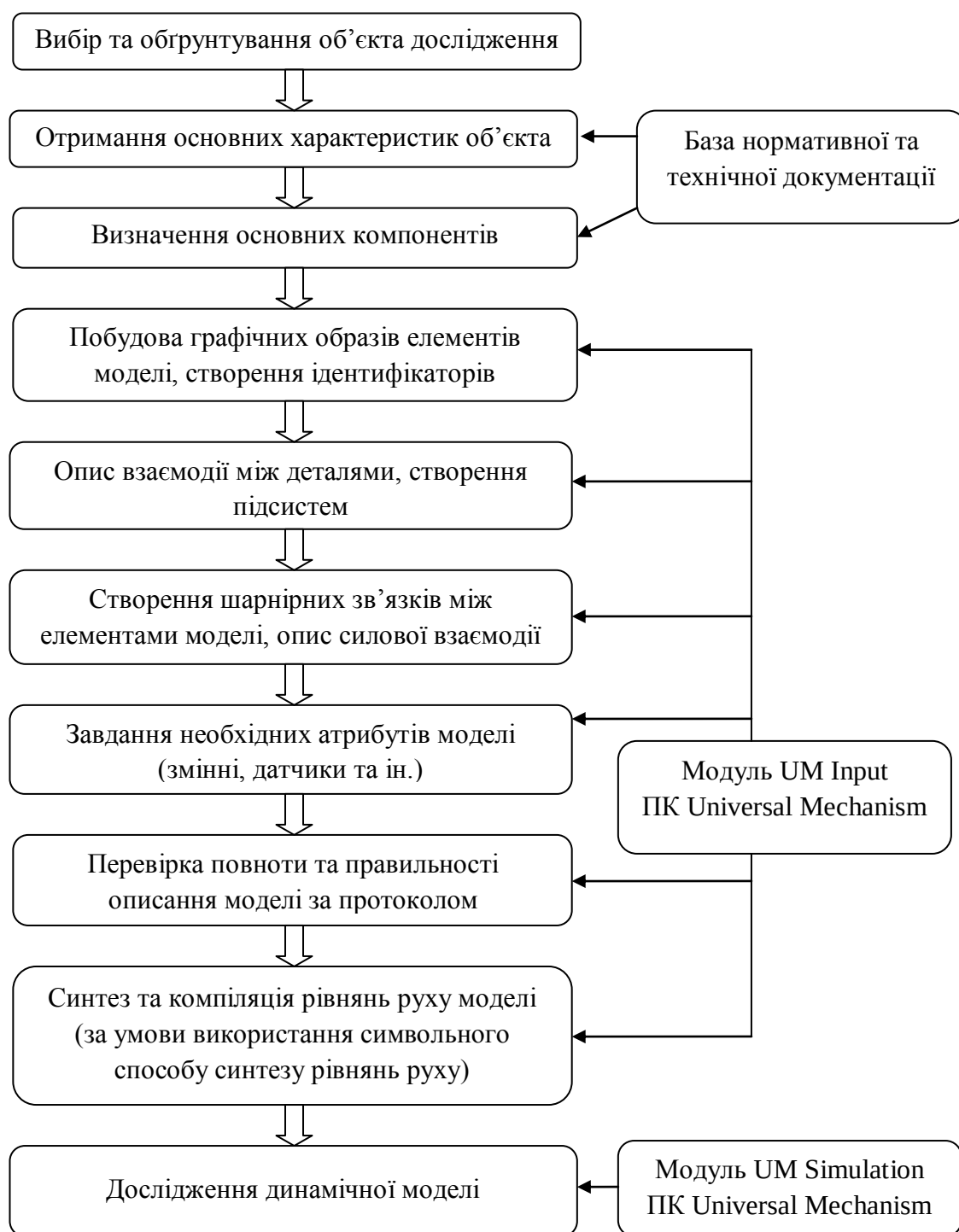
Рисунок 3.10 – Алгоритм підготовки динамічної моделі автопоїзда в ПК UM
