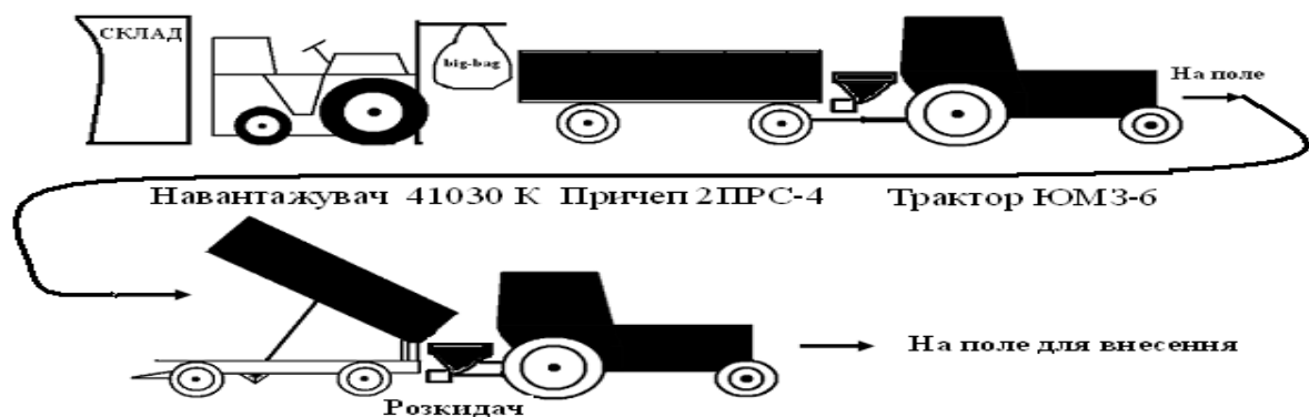
Рисунок 4.6 – Схема технологічної лінії підкормки міндобривами за допомогою наземних транспортних засобів *
