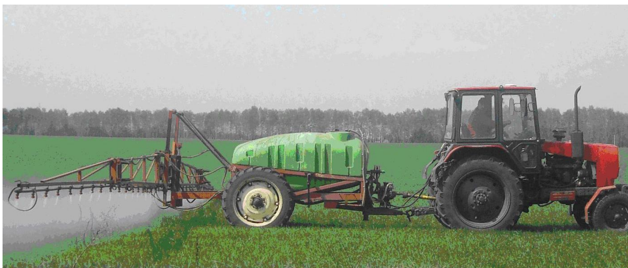
Рисунок Р.6 – Обприскувач ОПШ-2000 в агрегаті з трактором ЮМЗ-6
