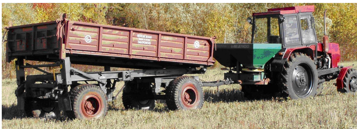
Рисунок Р.2 – Трактор ЮМЗ-6 в агрегаті з причепом 2ПТС-4 і розкидачем мінеральних добрив МРД-1000 в транспортному положенні
