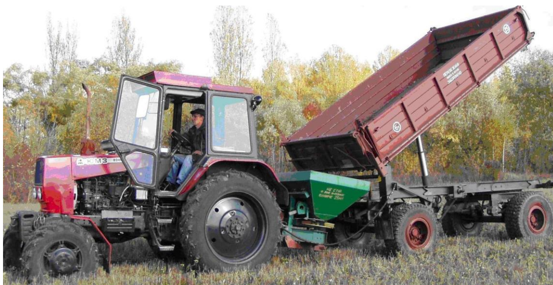
Рисунок Р.3 – Трактор ЮМЗ-6 в агрегаті з причепом 2ПТС-4 і розкидачем мінеральних добрив МРД-1000 при завантаженні добрив в розкидач
