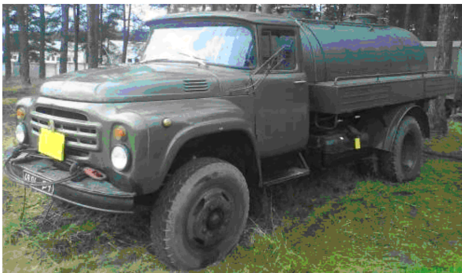
Рисунок Р.5 – Автоцистерна для перевезення води АЦПТ-5
