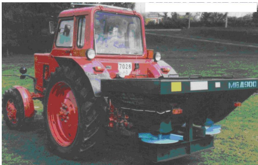
Рисунок Р.4 – Розкидач мінеральних добрив МБД-900 в агрегаті з трактором ЮМЗ-6
